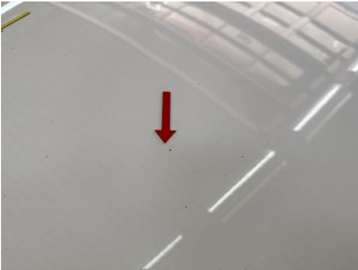
Motorhaube (Steinschlag, Rost)
