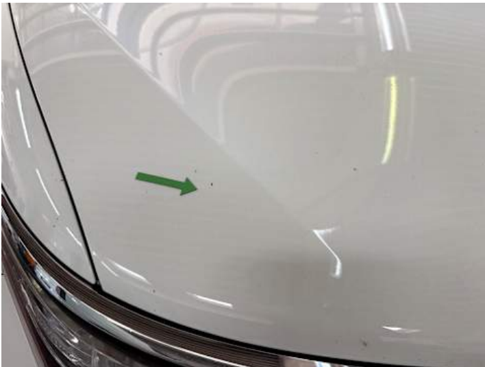
Motorhaube (Steinschlag, Rost)
