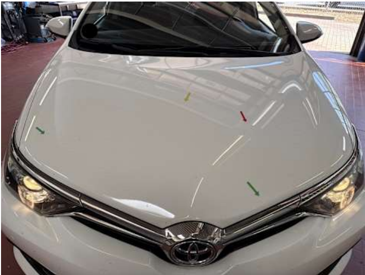
Motorhaube (Steinschlag, Rost)
