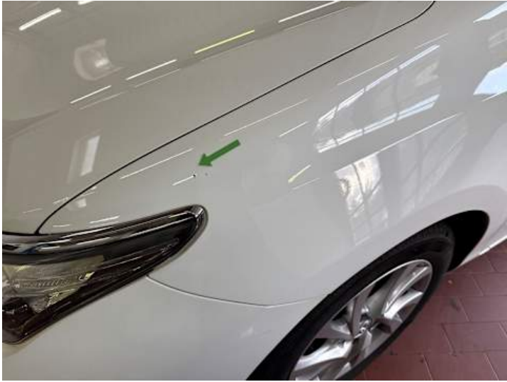
Kotflügel vorne links (Steinschlag, Rost)
