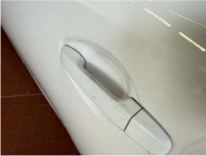
Türe hinten links (Lackschaden, Kratzer)
