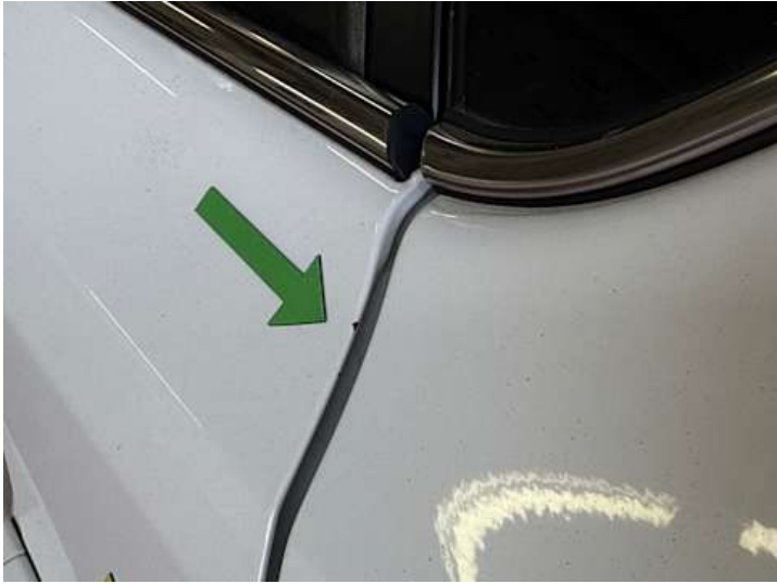
Türe hinten links (Lackschaden, Kratzer)
