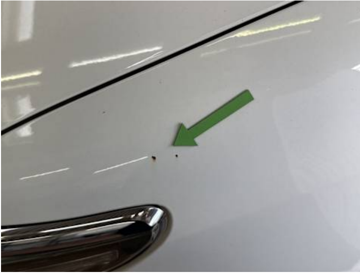
Kotflügel vorne links (Steinschlag, Rost)
