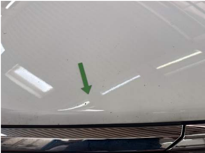
Motorhaube (Steinschlag, Rost)
