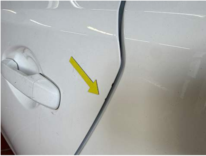
Türe hinten links (Lackschaden, Kratzer)
