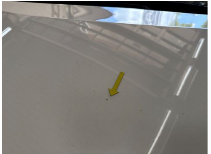
Motorhaube (Steinschlag, Rost)
