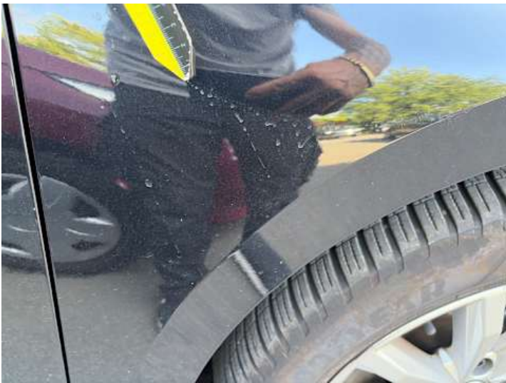
Kotflügel vorne rechts (Lackschaden, Kratzer)
