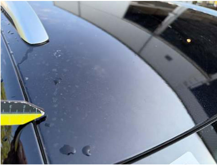
Dach (Lackschaden, Kratzer)
