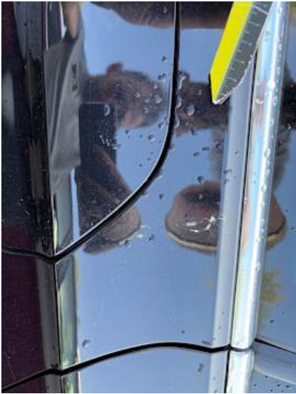
Seitenteil hinten rechts (Lackschaden, Kratzer)
