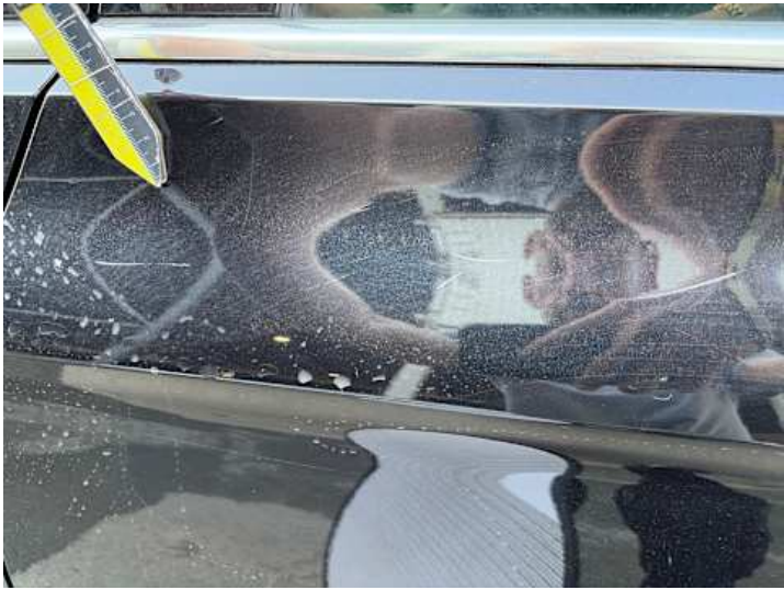
Türe hinten links (Lackschaden, Kratzer)
