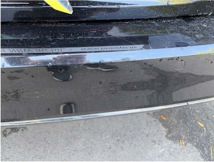
Stoßstange hinten (Lackschaden, Kratzer)
