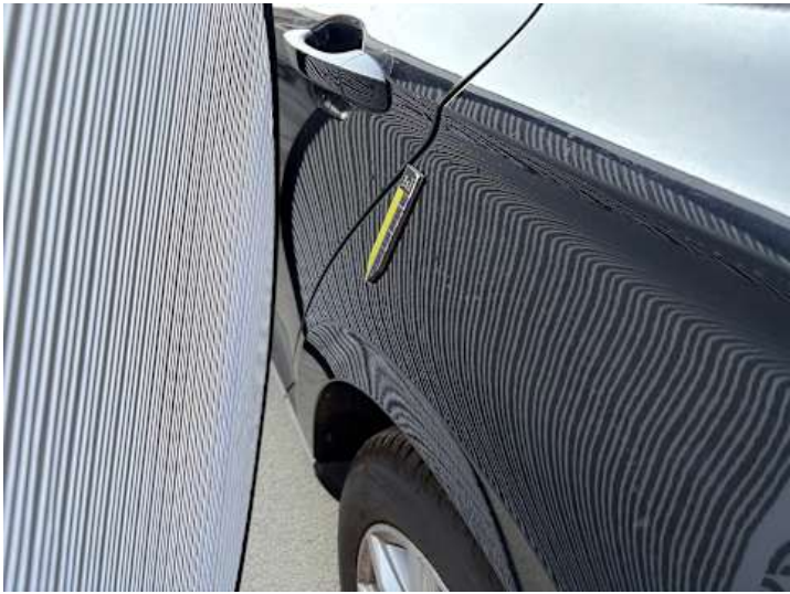
Seitenteil hinten links (Delle)
