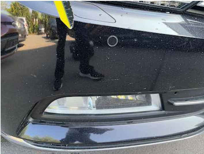
Stoßstange vorne (Lackschaden, Kratzer)
