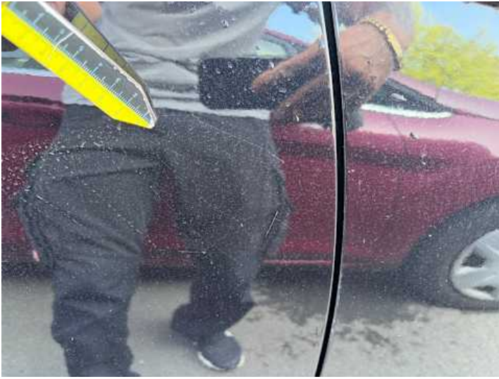
Türe hinten rechts (Lackschaden, Kratzer)
