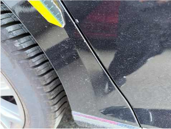
Seitenteil hinten rechts (Lackschaden, Kratzer)
