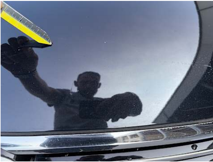
Motorhaube (Lackschaden, Kratzer, Steinschlag)
