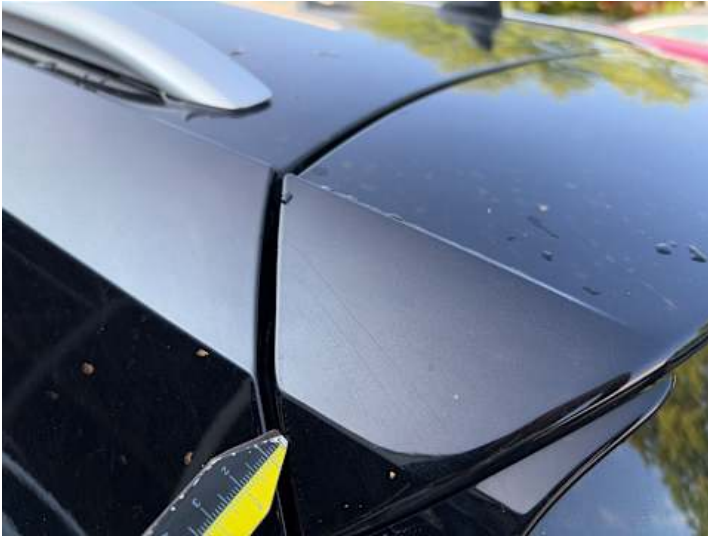
Dach (Lackschaden, Kratzer)
