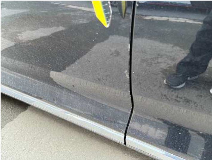
Fahrtür (Lackschaden, Kratzer)
