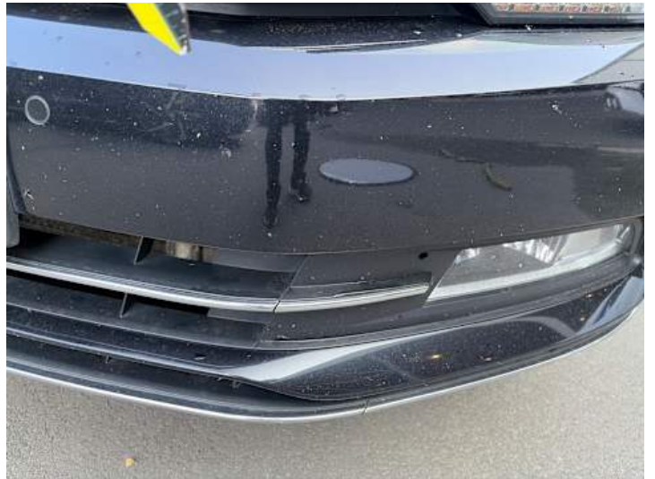
Stoßstange vorne (Lackschaden, Kratzer)
