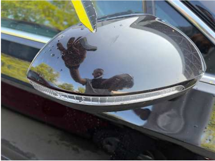
Beifahrertür (Lackschaden, Kratzer)
