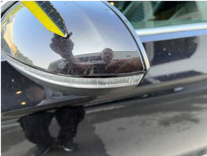
Fahrtür (Lackschaden, Kratzer)
