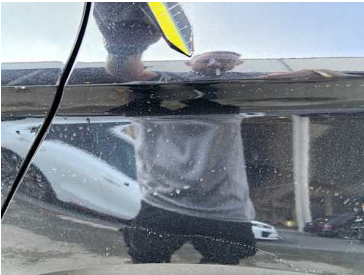
Seitenteil hinten links (Lackschaden, Kratzer)
