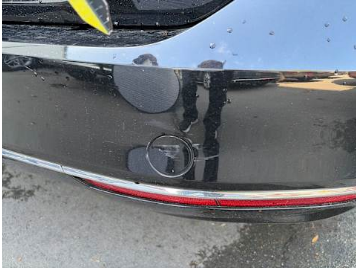
Stoßstange hinten (Lackschaden, Kratzer)
