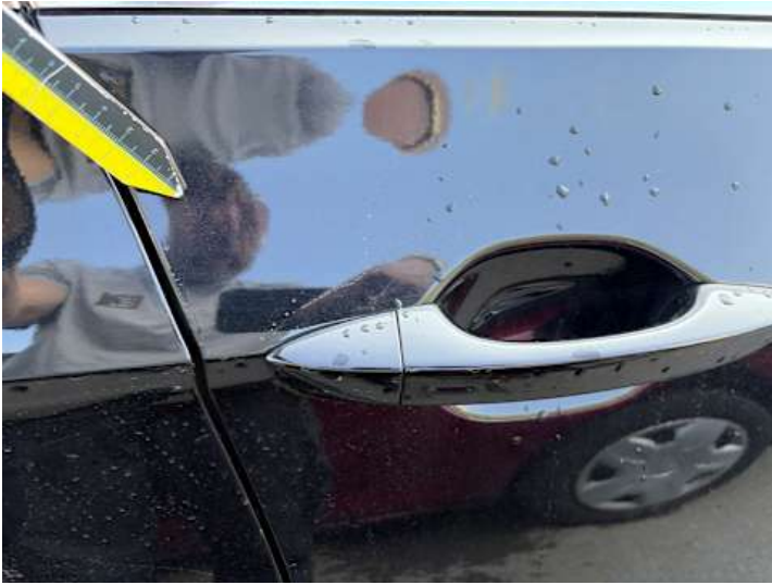
Beifahrertür (Lackschaden, Kratzer)
