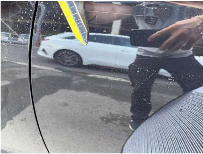
Türe hinten links (Lackschaden, Kratzer)
