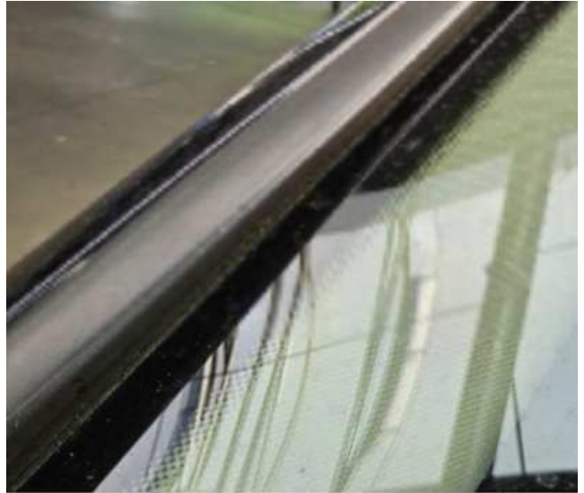
Windschutzscheibe (Anderer Schaden): Leiste verbogen
