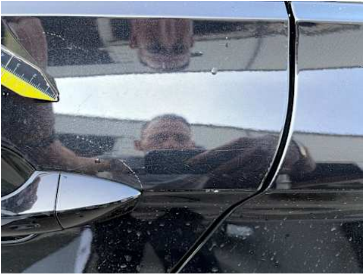
Türe hinten links (Lackschaden, Kratzer)
