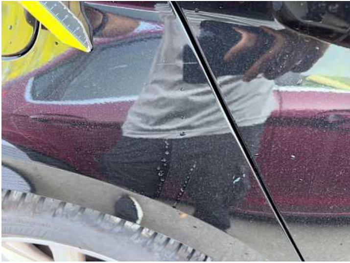
Seitenteil hinten rechts (Lackschaden, Kratzer)
