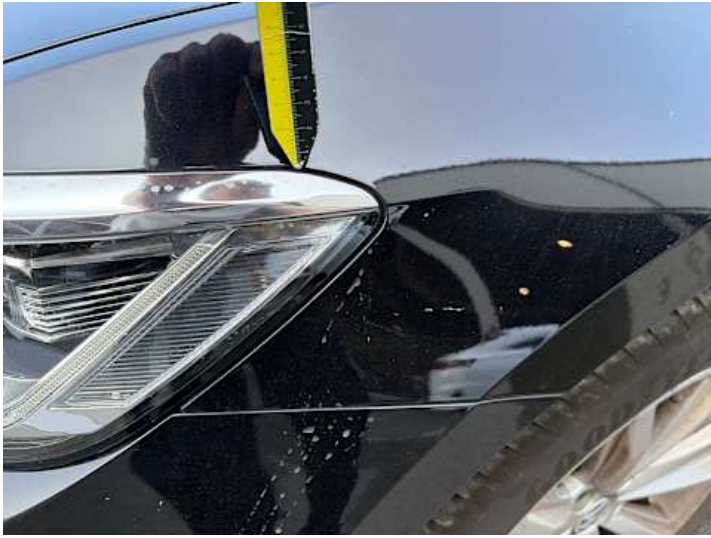
Kotflügel vorne links (Lackschaden, Kratzer)
