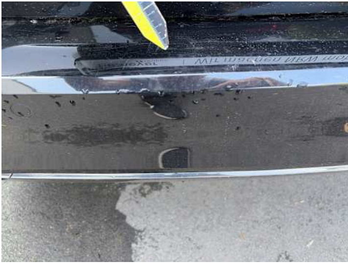
Stoßstange hinten (Lackschaden, Kratzer)
