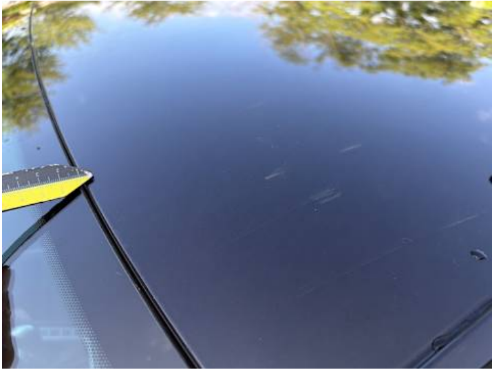
Dach (Lackschaden, Kratzer)
