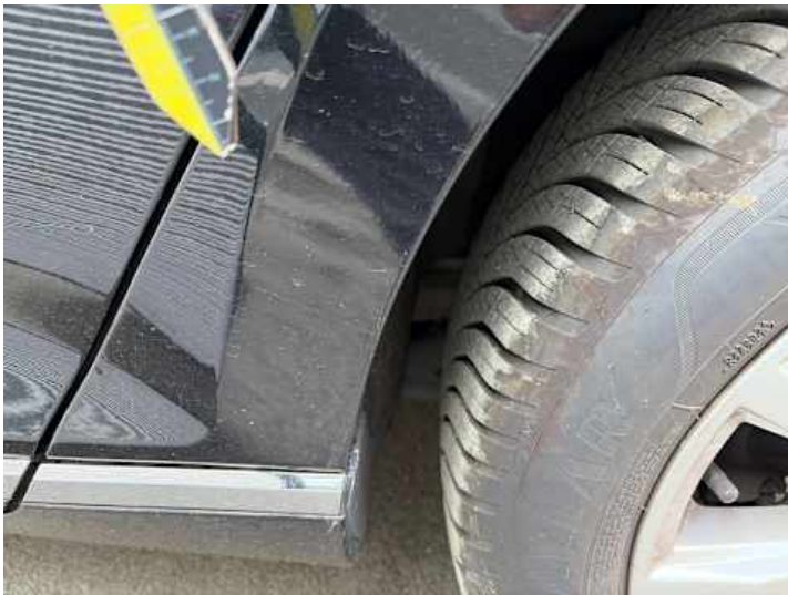
Seitenteil hinten links (Lackschaden, Kratzer)
