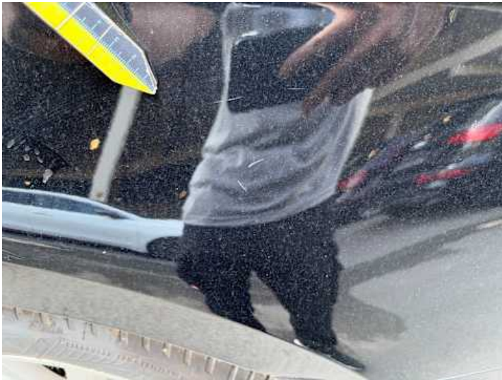
Seitenteil hinten links (Lackschaden, Kratzer)
