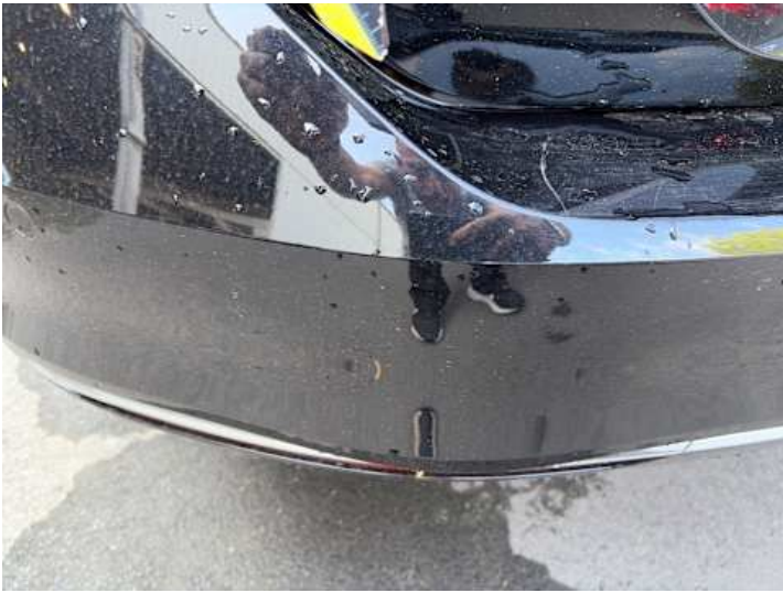
Stoßstange hinten (Lackschaden, Kratzer)
