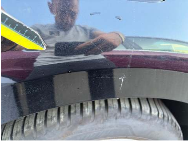
Seitenteil hinten rechts (Lackschaden, Kratzer)
