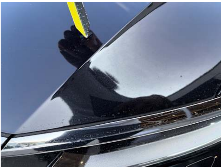
Motorhaube (Lackschaden, Kratzer, Steinschlag)
