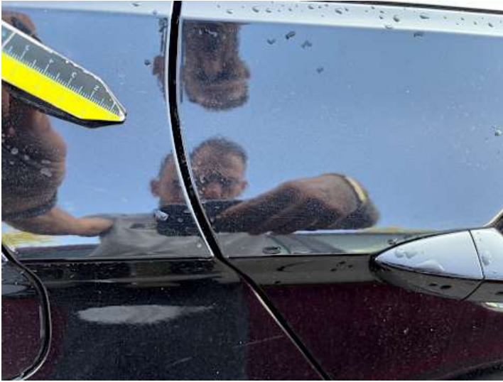
Türe hinten rechts (Lackschaden, Kratzer)
