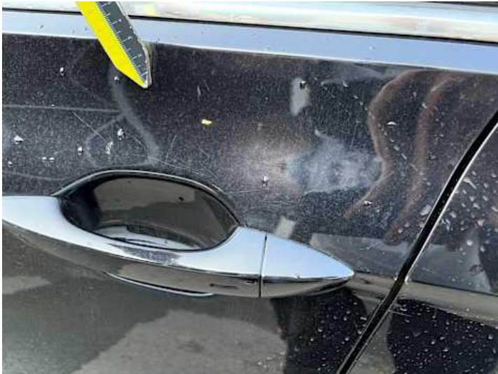
Fahrtür (Lackschaden, Kratzer)
