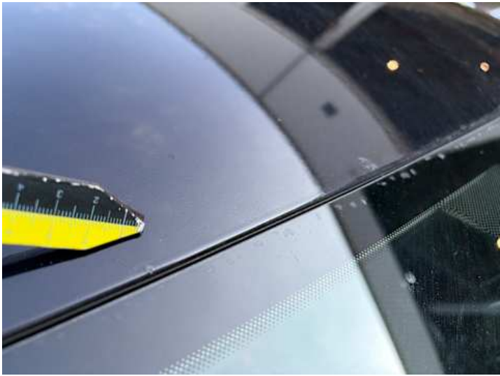
Dach (Lackschaden, Kratzer)
