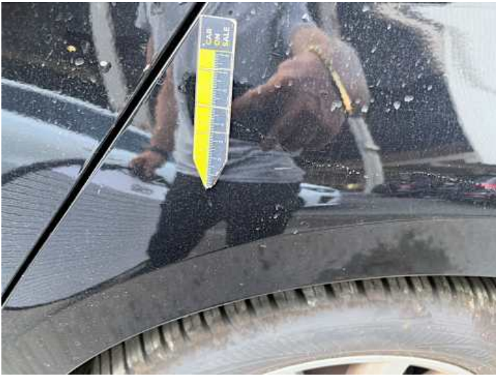
Seitenteil hinten links (Lackschaden, Kratzer)
