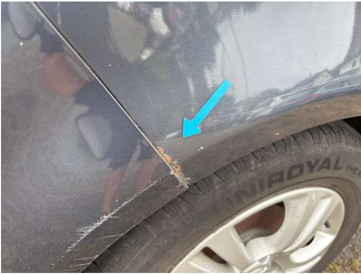
Seitenteil hinten rechts (Delle, Rost, Lackschaden)
