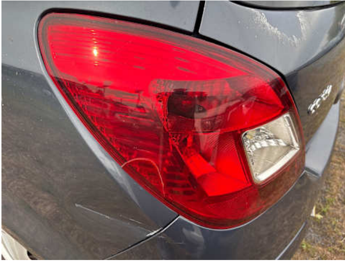
Rücklicht (links) (Riss/Bruch)
