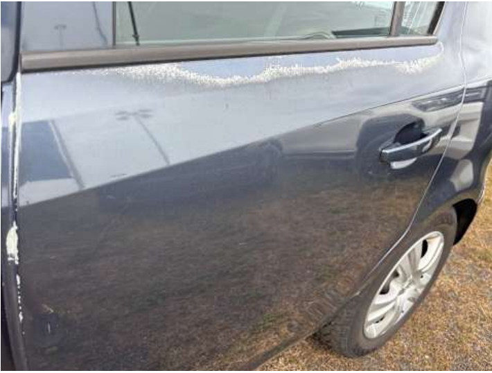
Türe hinten links (Lackschaden)
