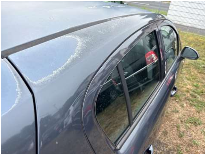
Seitenteil hinten rechts (Delle, Rost, Lackschaden)
