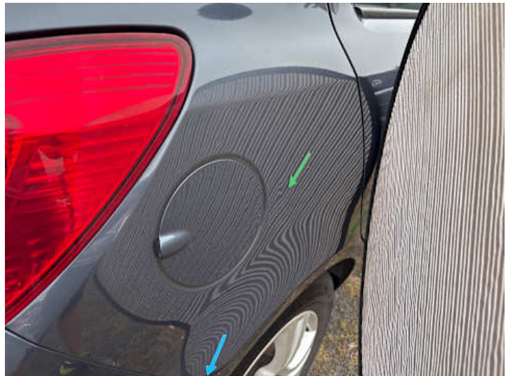
Seitenteil hinten rechts (Delle, Rost, Lackschaden)
