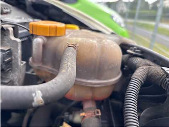
Motorhaube (Anderer Schaden): Kühlmittelstand zu gering,
