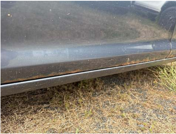
Fahrtür (Lackschaden, Rost)
