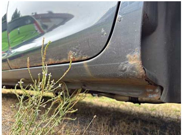
Schweller links (Rost)
