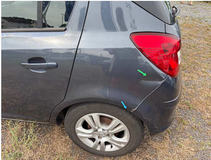
Seitenteil hinten links (Delle, Lackschaden, Rost)
