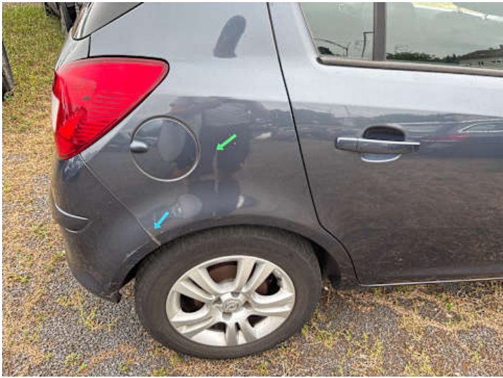
Seitenteil hinten rechts (Delle, Rost, Lackschaden)
