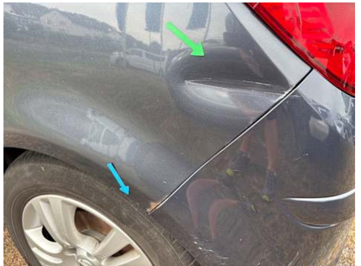
Seitenteil hinten links (Delle, Lackschaden, Rost)
