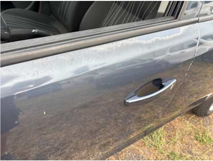
Fahrtür (Lackschaden, Rost)
