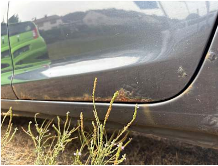
Türe hinten links (Rost)
