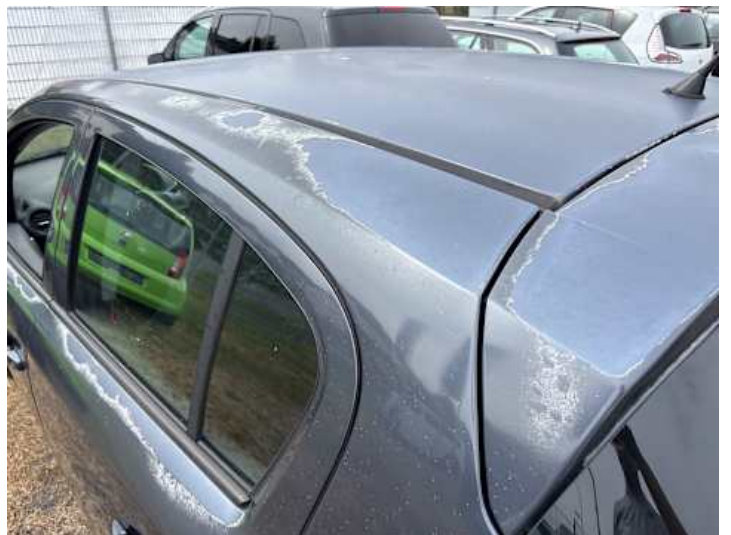
Seitenteil hinten links (Delle, Lackschaden, Rost)
