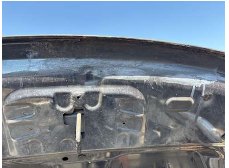
Motorhaube (Unsachgemäß instand gesetzt)
