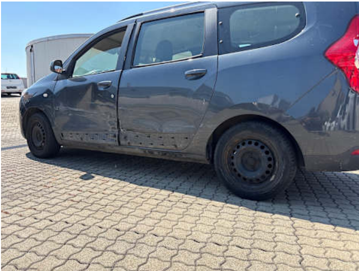
Türe hinten links (Unsachgemäß instand gesetzt)
