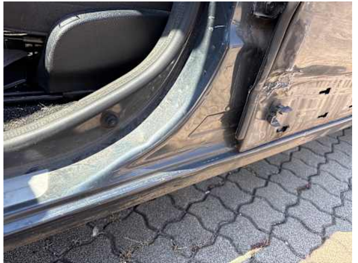
Schweller links (Verformung)
