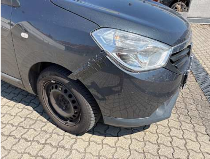
Stoßstange vorne (Unsachgemäß instand gesetzt)
