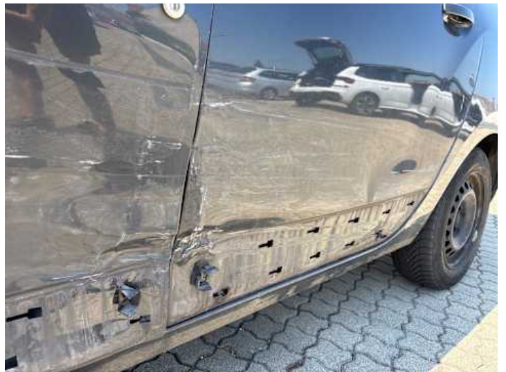
Türe hinten links (Unsachgemäß instand gesetzt)
