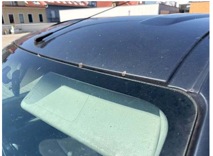
Dach (Steinschlag, Rost)
