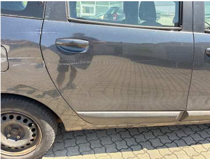
Türe hinten rechts (Kratzer, Verformung)
