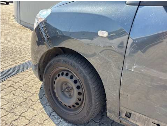
Kotflügel vorne links (Verformung)
