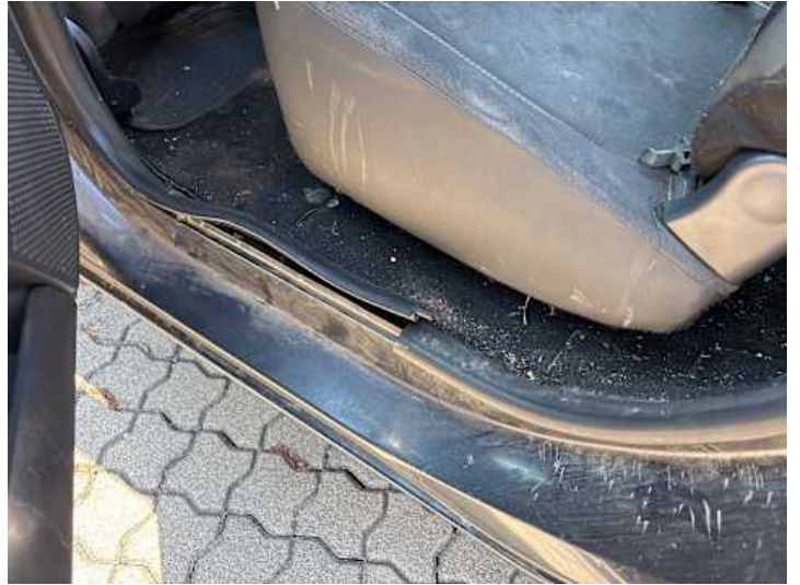
Innenraum (Ohne Funktion, Riss/Bruch, Verschleiß, Verschmutzung)
