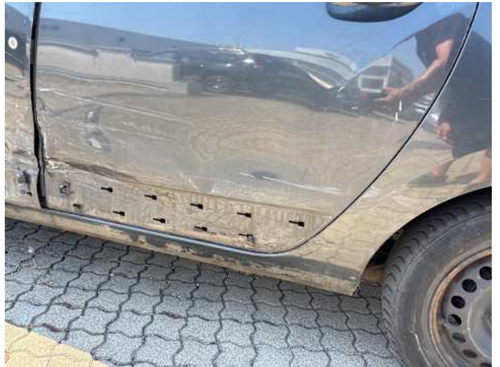
Türe hinten links (Unsachgemäß instand gesetzt)
