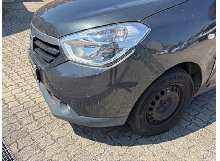
Stoßstange vorne (Unsachgemäß instand gesetzt)
