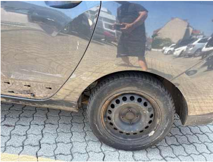
Seitenteil hinten links (Verformung, Kratzer)
