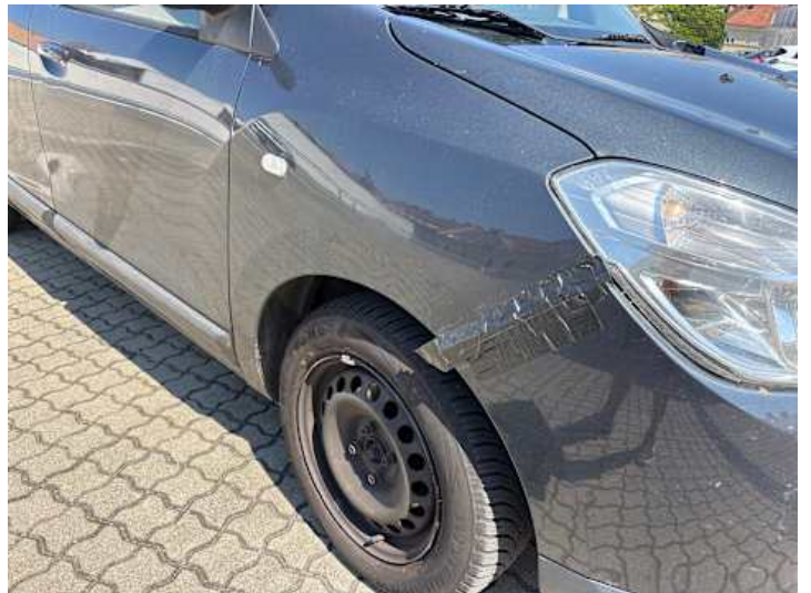
Kotflügel vorne rechts (Verformung, Delle)
