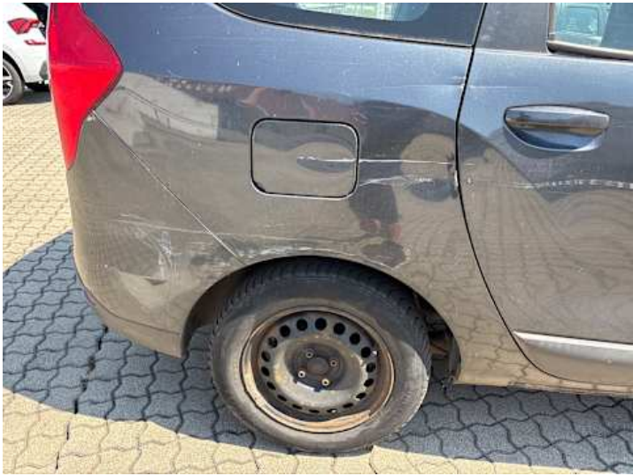
Seitenteil hinten rechts (Kratzer, Verformung)
