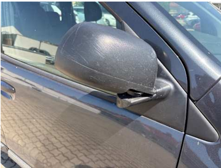
Beifahrertür (Riss/Bruch, Delle, Kratzer, Lackschaden)
