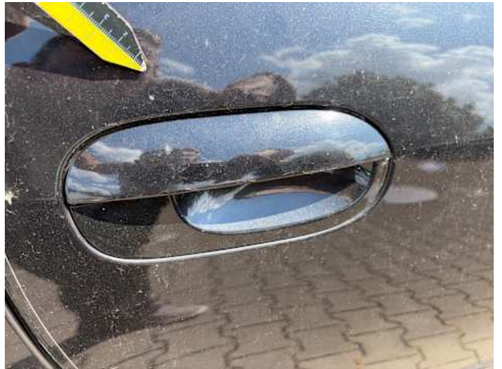
Beifahrtür (Lackschaden, Kratzer)
