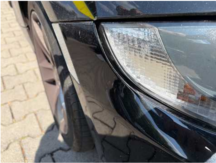
Stoßstange vorne (Spaltmaße ungenau)
