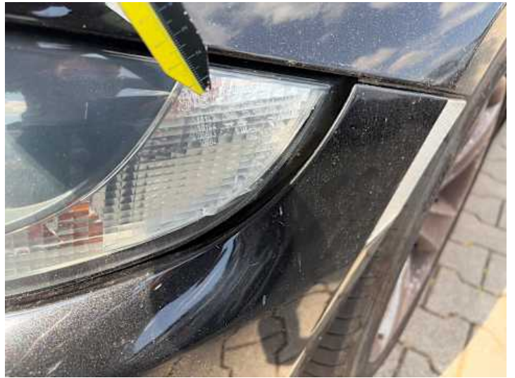
Stoßstange vorne (Spaltmaße ungenau)
