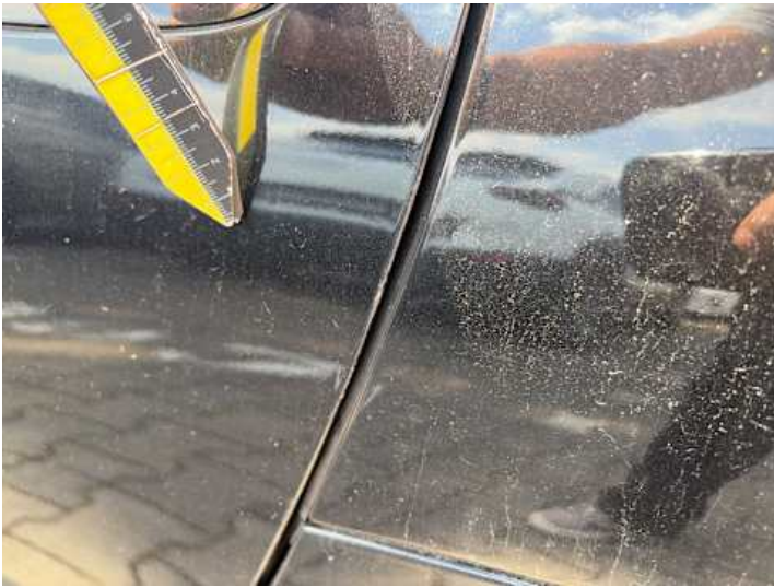
Fahrtür (Lackschaden, Kratzer)
