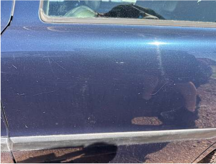
Türe hinten links (Kratzer)
