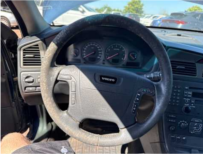
Innenraum (Anderer Schaden, Wassereintritt): Schimmel
