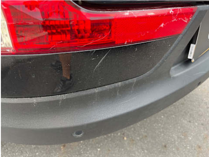
Stoßstange hinten (Lackschaden, Kratzer)
