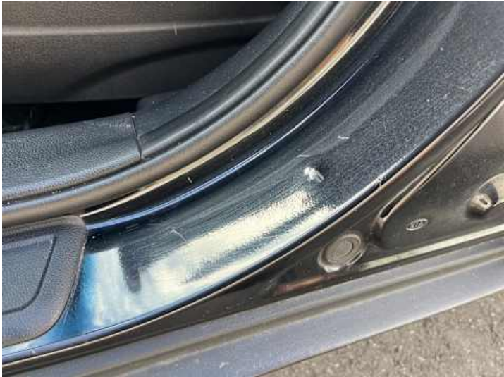
Schweller links (Lackschaden, Delle, Kratzer)
