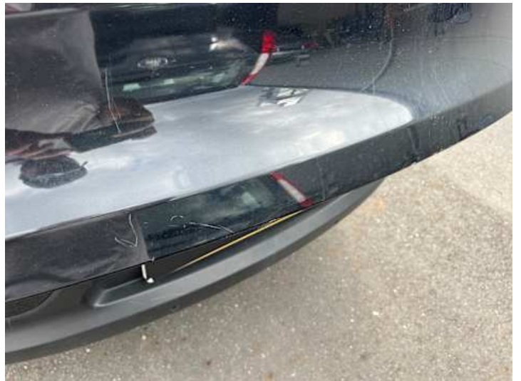
Heckklappe (Lackschaden, Kratzer)
