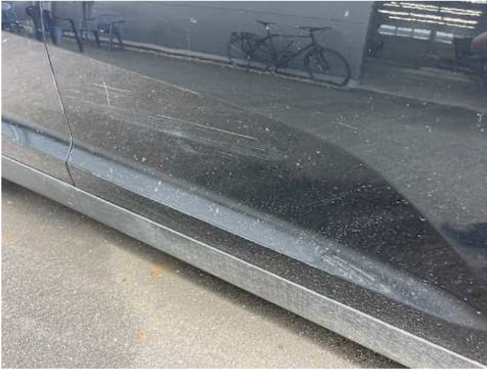
Beifahrertür (Lackschaden, Kratzer)
