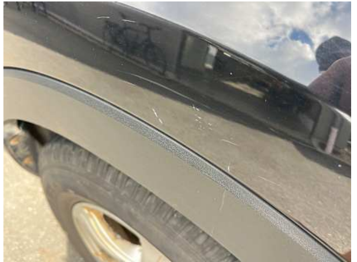
Kotflügel vorne rechts (Lackschaden, Kratzer)
