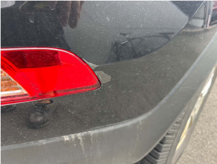
Stoßstange hinten (Lackschaden, Kratzer)
