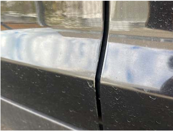
Fahrertür (Lackschaden, Kratzer)
