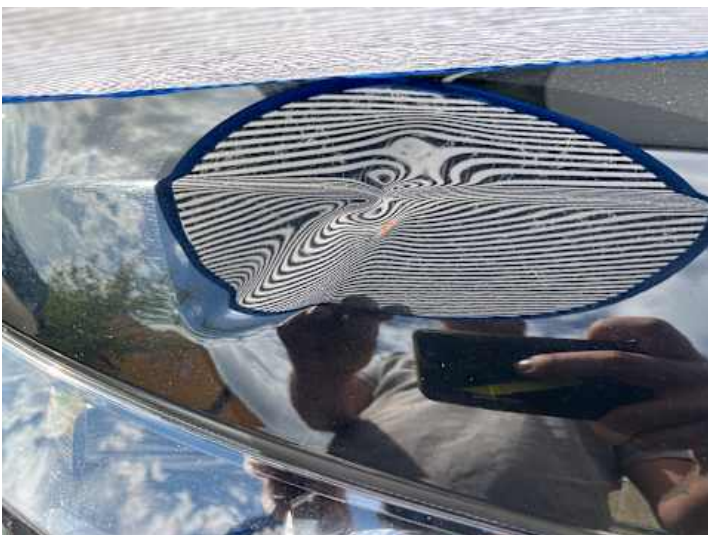
Motorhaube (Delle, Lackschaden, Rost)
