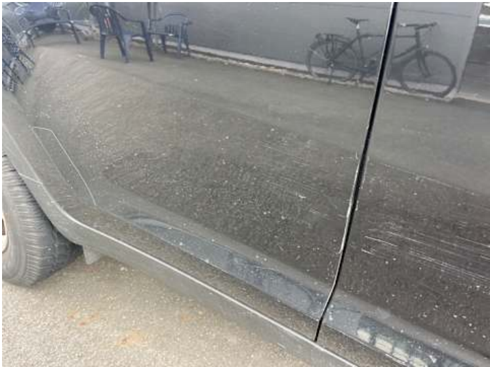
Türe hinten rechts (Lackschaden, Kratzer, Verformung)
