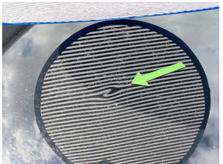
Motorhaube (Delle, Lackschaden, Rost)
