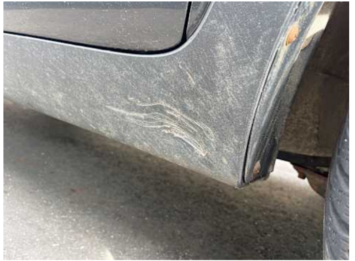
Schweller rechts (Kratzer, Verformung)
