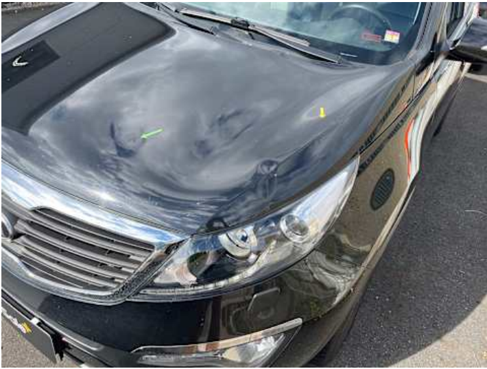
Motorhaube (Delle, Lackschaden, Rost)
