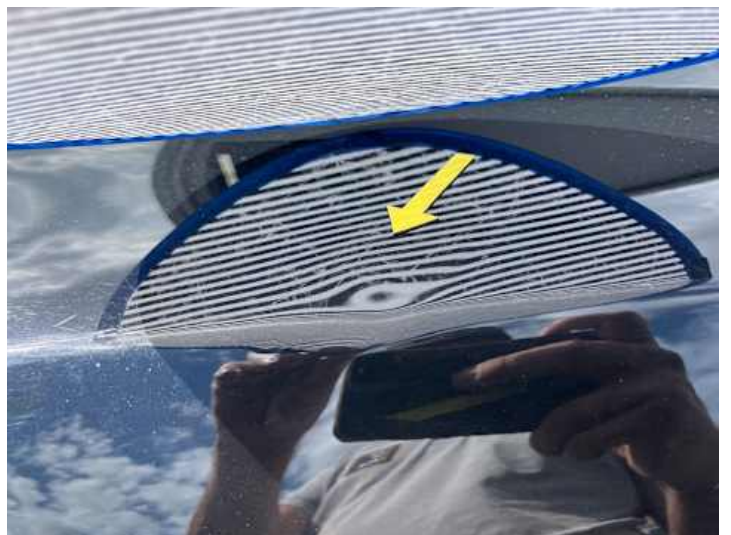
Motorhaube (Delle, Lackschaden, Rost)
