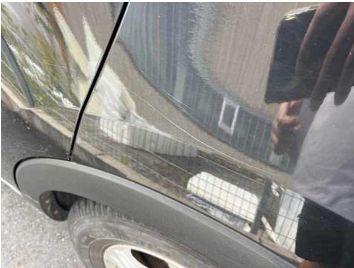
Seitenteil hinten links (Lackschaden, Kratzer)
