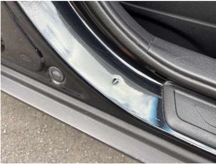
Schweller rechts (Lackschaden, Kratzer, Delle)
