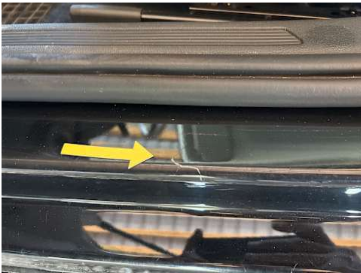
Schweller links (Kratzer)
