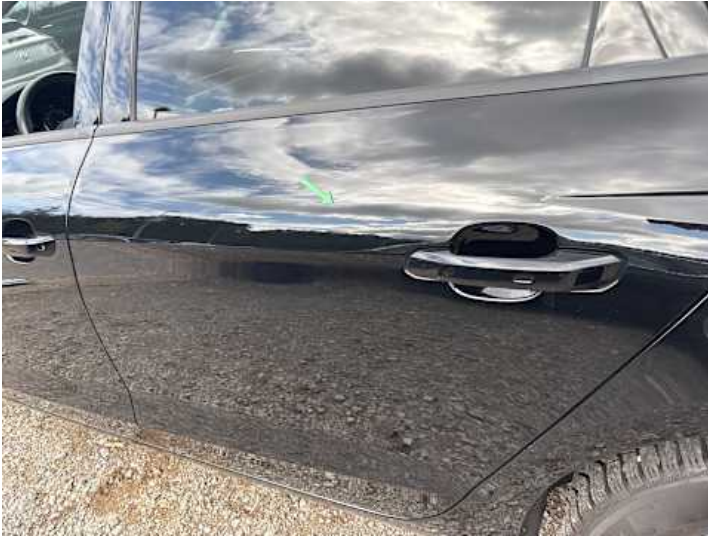
Türe hinten links (Delle, Kratzer)
