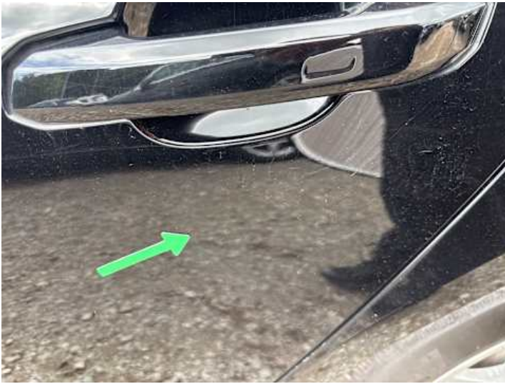
Türe hinten links (Delle, Kratzer)
