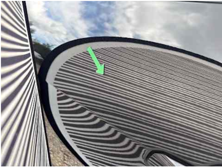
Türe hinten links (Delle, Kratzer)
