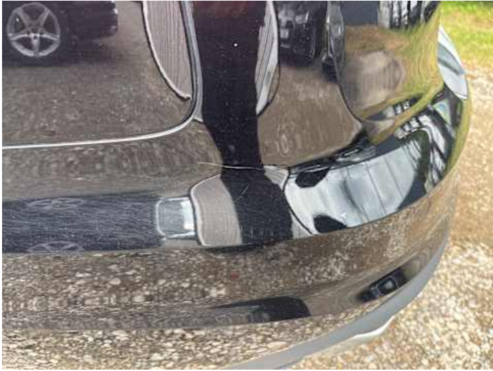
Stoßstange hinten (Kratzer)
