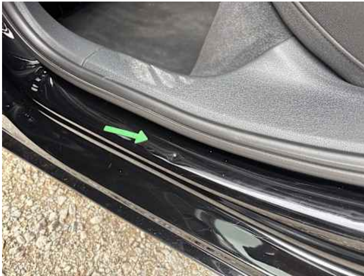
Schweller links (Delle)
