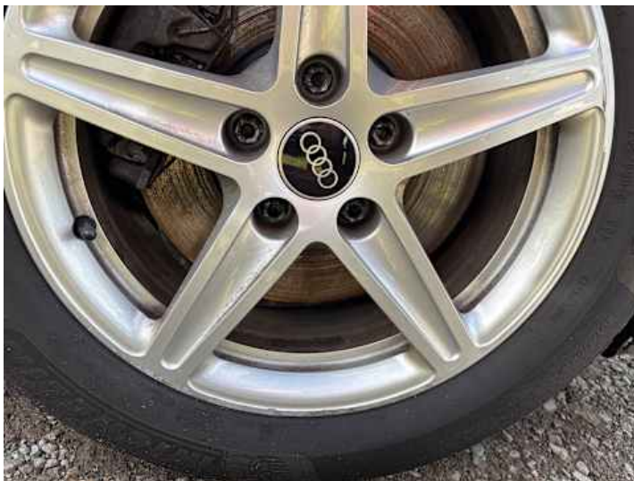
Rad (Kerben, Kratzer, Rost)
