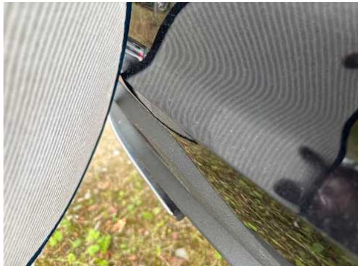
Stoßstange hinten (Lackschaden, Verformung)
