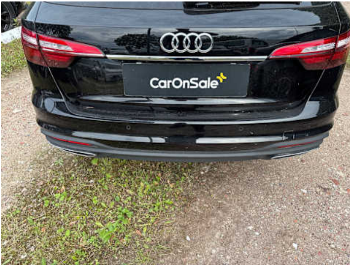
Stoßstange hinten (Lackschaden, Verformung)
