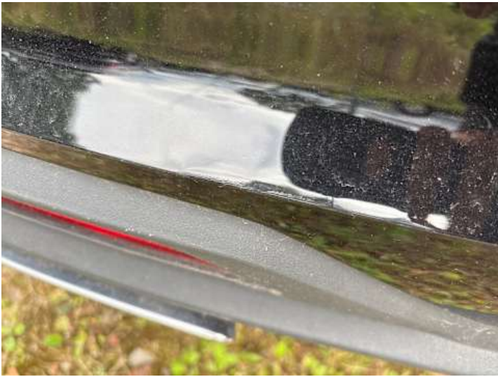
Stoßstange hinten (Lackschaden, Verformung)
