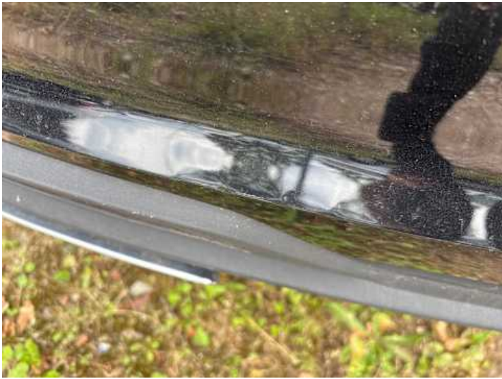
Stoßstange hinten (Lackschaden, Verformung)
