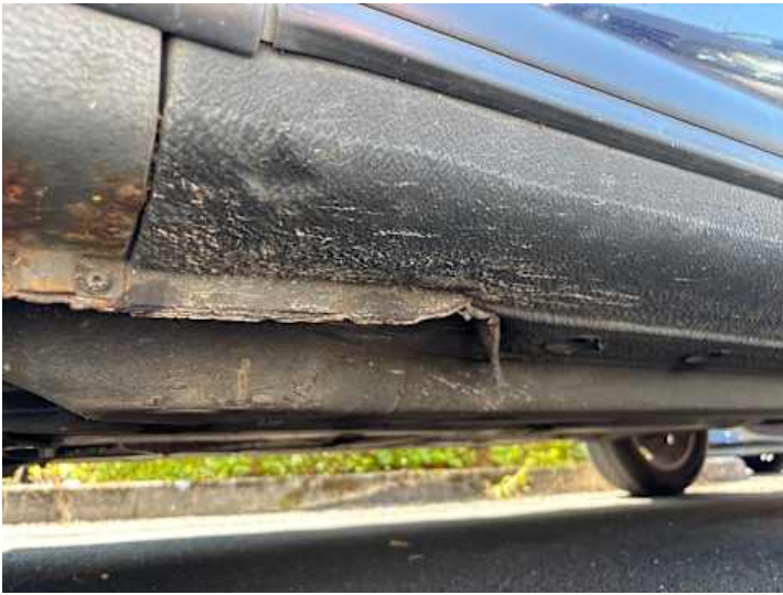
Schweller links (Verformung, Lackschaden)
