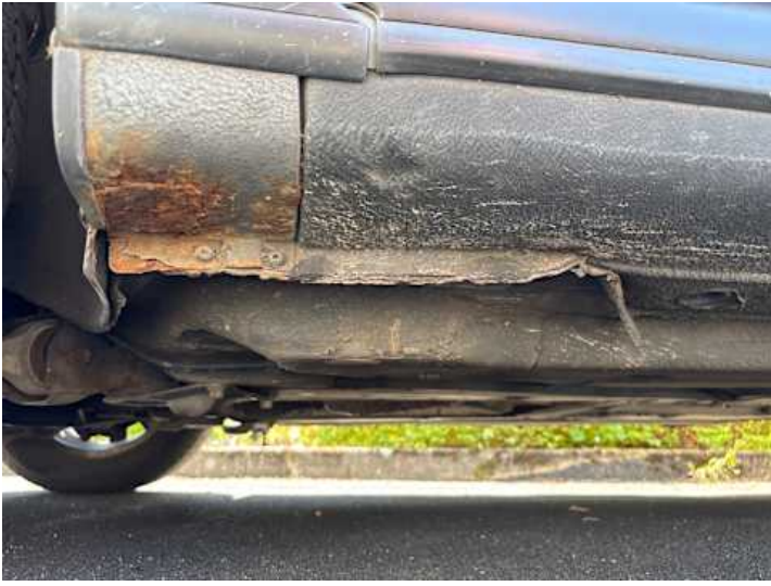
Kotflügel vorne links (Rost)
