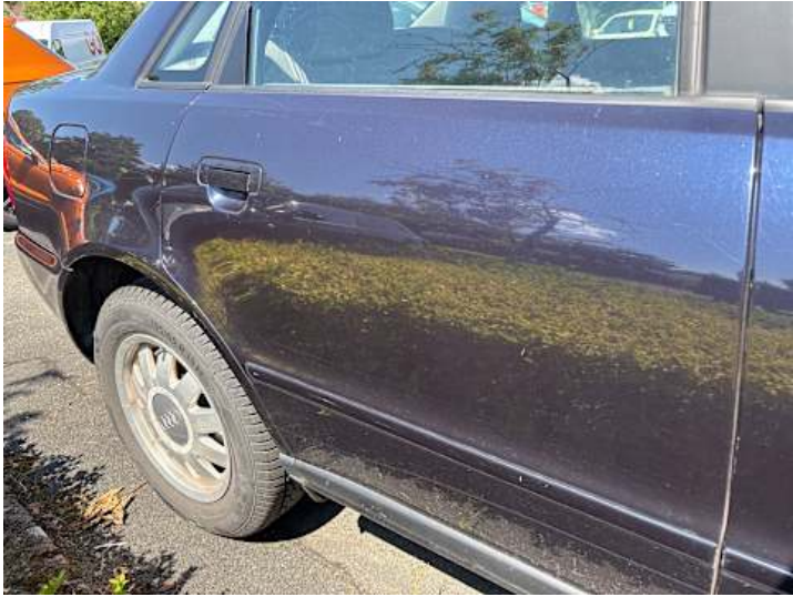
Türe hinten rechts (Kratzer, Lackschaden)
