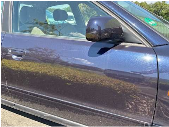
Beifahrertür (Lackschaden, Kratzer)
