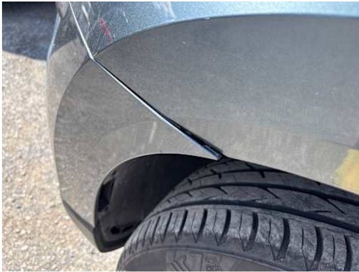
Stoßstange vorne (Spaltmaße ungenau)
