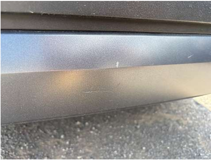
Stoßstange hinten (Kratzer)
