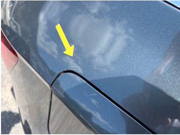
Seitenteil hinten rechts (Kratzer)
