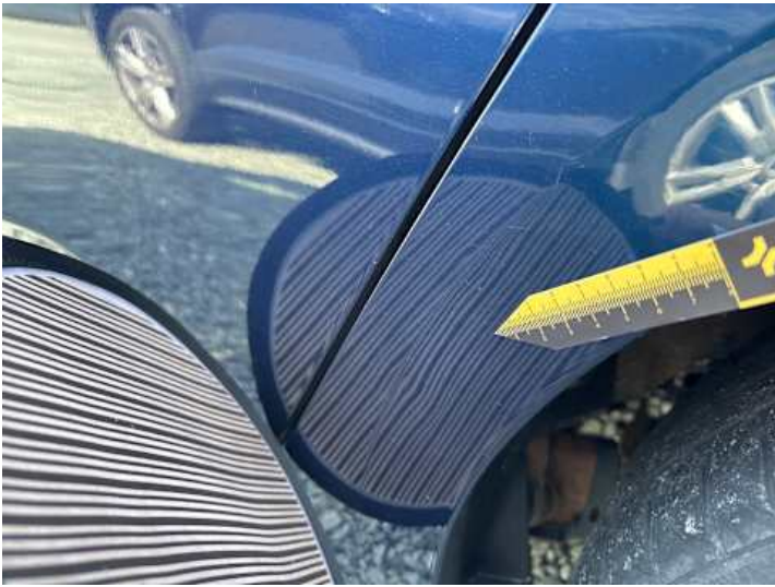
Seitenteil hinten links (Delle, Verformung)
