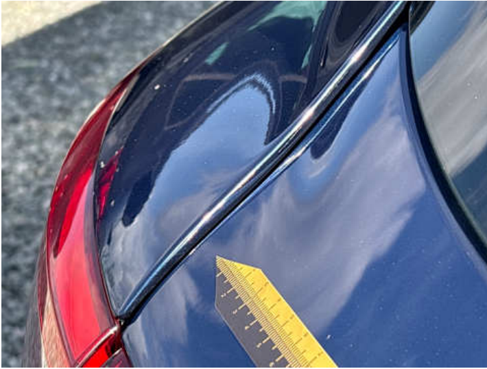
Heckklappe (Spaltmaße ungenau)
