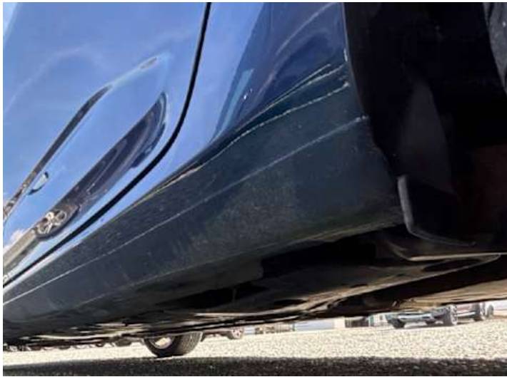
Schweller links (Verformung)
