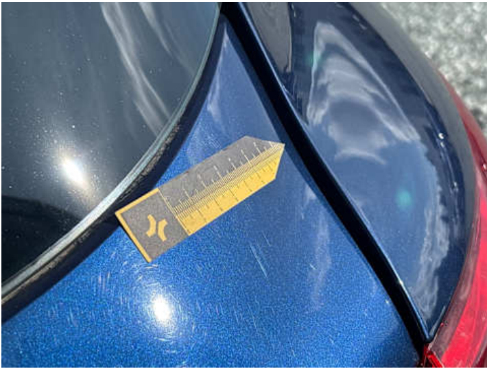
Heckklappe (Spaltmaße ungenau)
