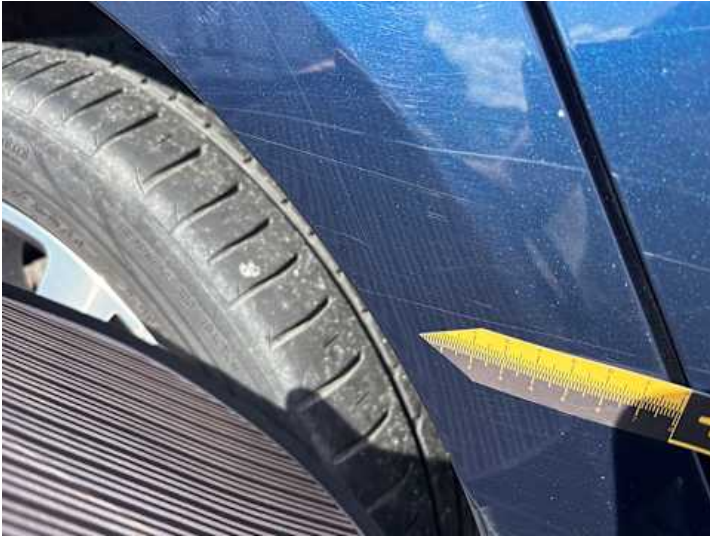
Seitenteil hinten rechts (Verformung)
