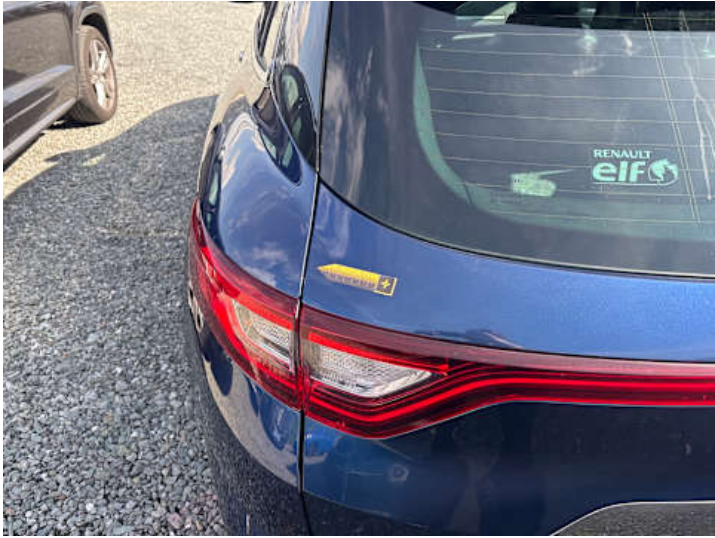
Heckklappe (Spaltmaße ungenau)
