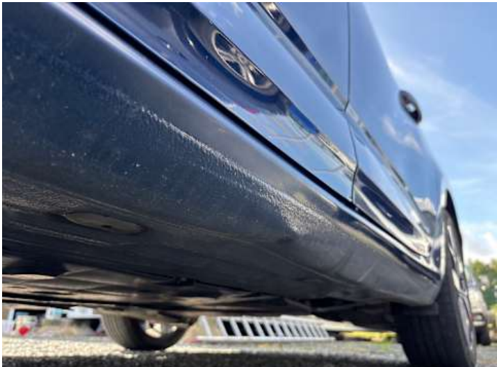
Schweller links (Verformung)
