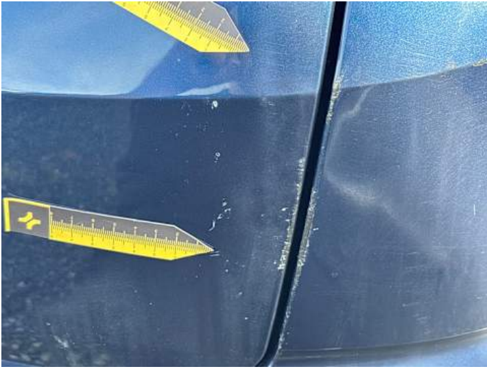
Heckklappe (Kratzer, Lackschaden)
