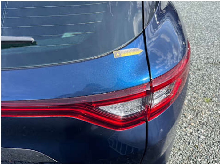
Heckklappe (Spaltmaße ungenau)
