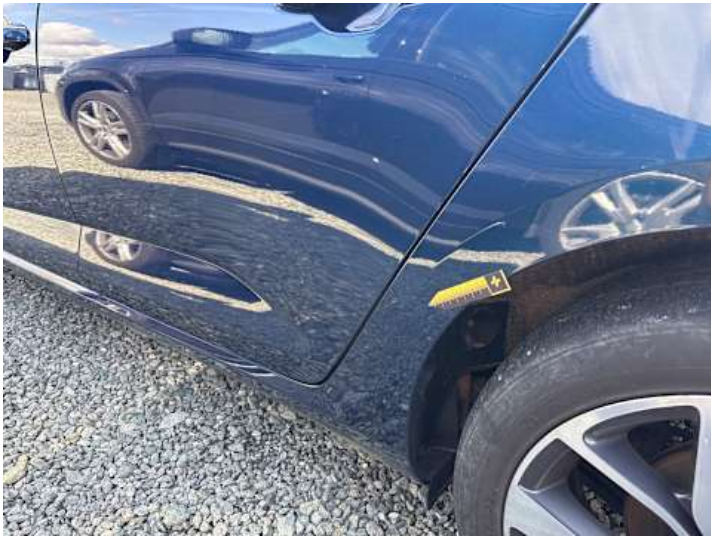
Seitenteil hinten links (Delle, Verformung)
