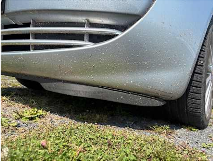
Stoßstange vorne (Riss/Bruch, Kratzer)
