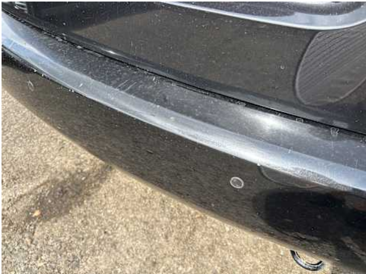
Stoßstange hinten (Kratzer, Verformung)
