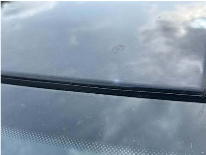
Dach (Lackschaden, Delle)
