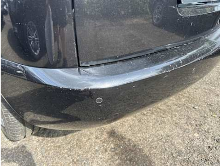
Stoßstange hinten (Kratzer, Verformung)
