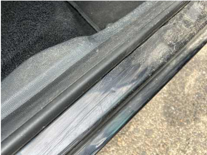
Schweller rechts (Delle, Kratzer)
