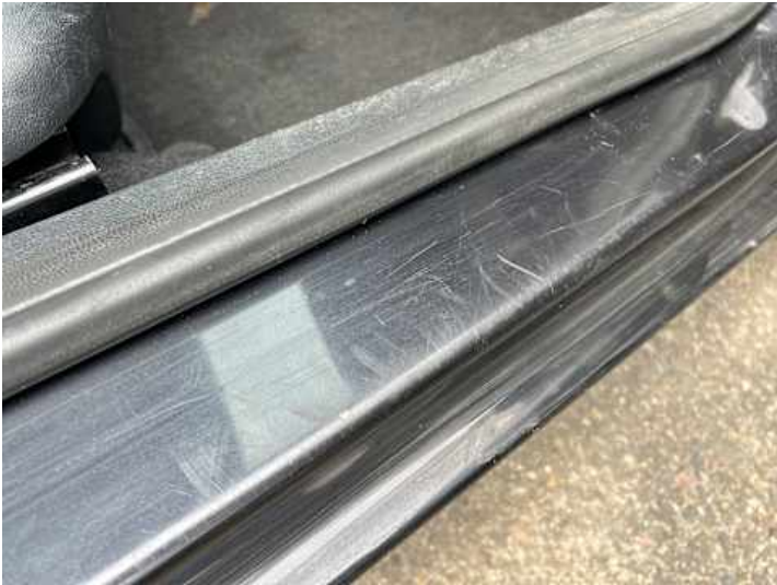
Schweller rechts (Delle, Kratzer)
