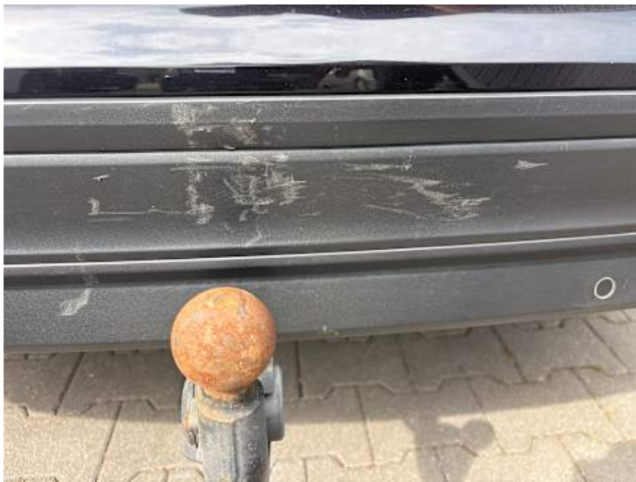
Stoßstange hinten (Kratzer)
