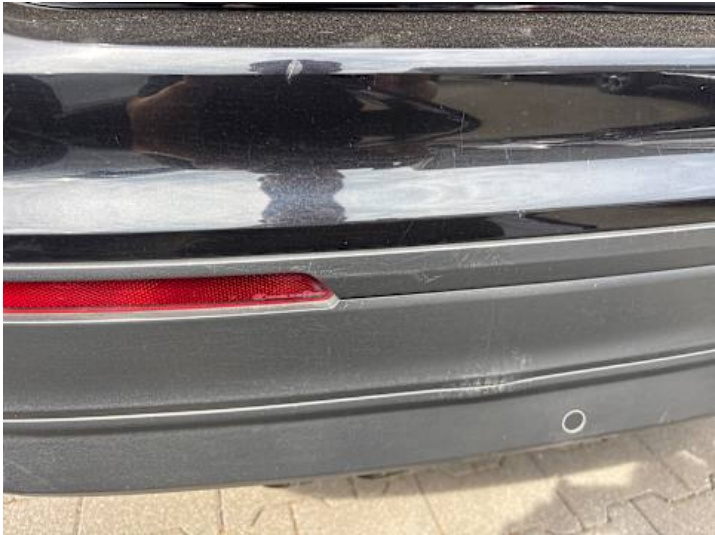
Stoßstange hinten (Kratzer)
