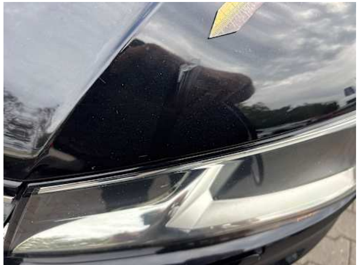
Motorhaube (Unsachgemäß instand gesetzt)
