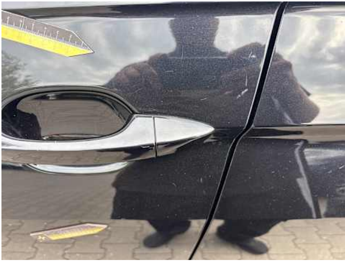
Fahrtür (Kratzer, Unsachgemäß instand gesetzt)
