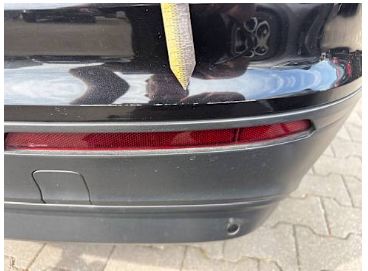
Stoßstange hinten (Kratzer)
