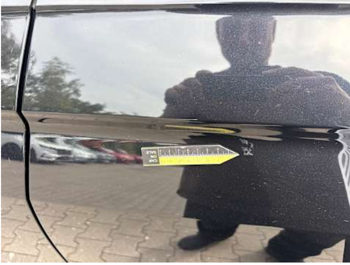
Türe hinten links (Lackschaden)
