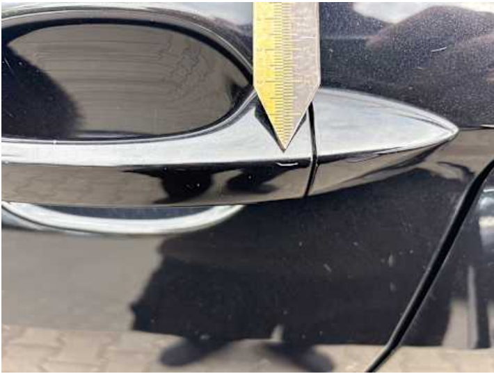
Fahrtür (Kratzer, Unsachgemäß instand gesetzt)
