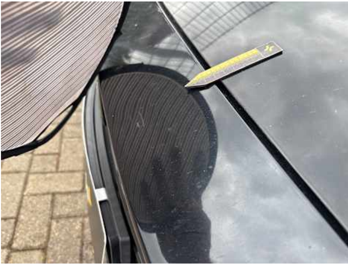
Stoßstange vorne (Delle, Kratzer)
