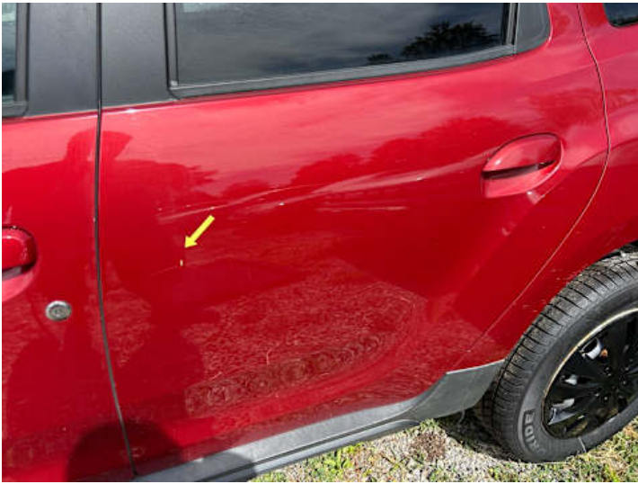
Türe hinten links (Kratzer)
