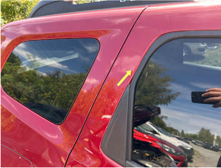
Türe hinten rechts (Delle)
