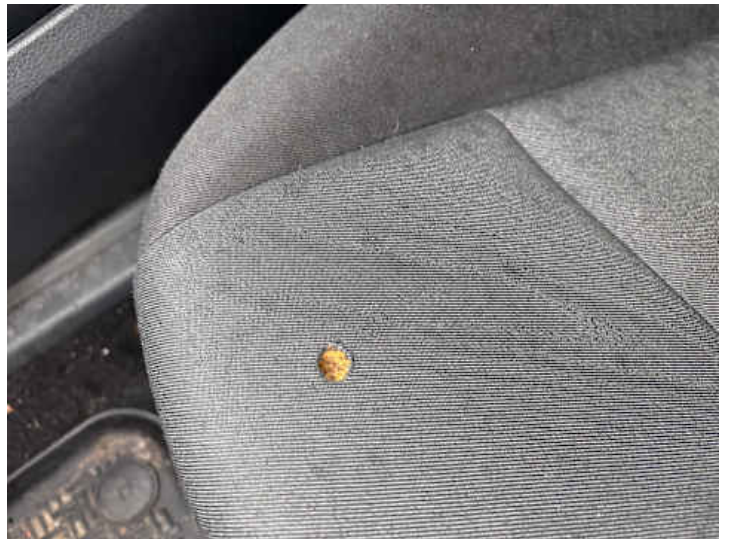
Innenraum (Brandloch, Verschmutzung)
