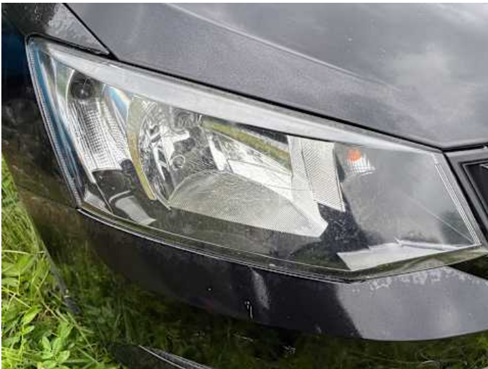
Scheinwerfer (rechts) (Riss/Bruch)
