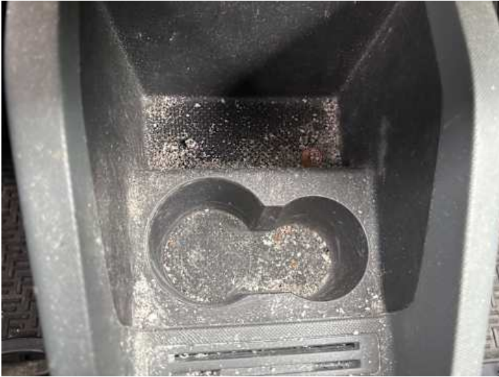
Innenraum (Brandloch, Verschmutzung)
