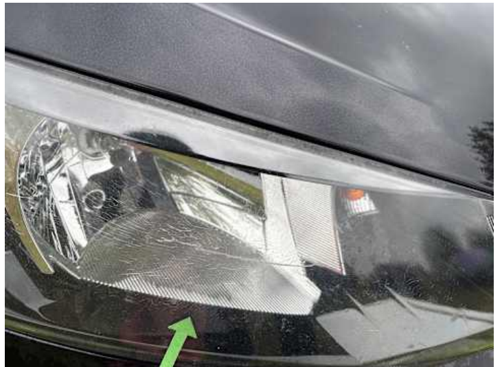
Scheinwerfer (rechts) (Riss/Bruch)
