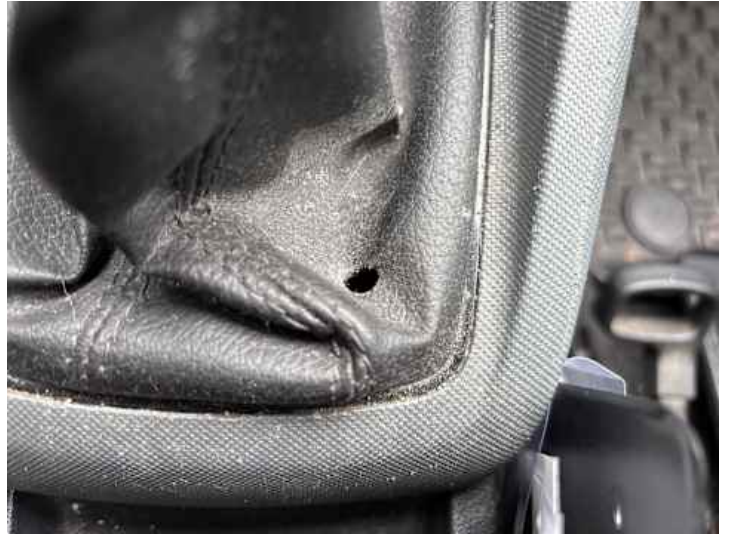
Innenraum (Brandloch, Verschmutzung)
