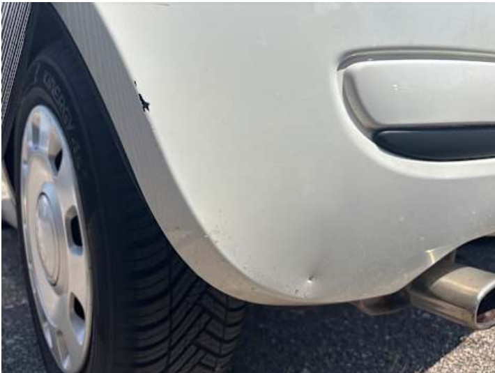
Stoßstange hinten (Lackschaden, Verformung)
