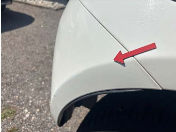
Stoßstange hinten (Kratzer, Lackschaden, Unsachgemäß instand gesetzt)
