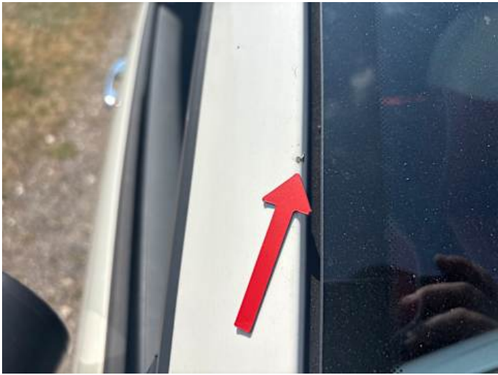
Dach (Steinschlag, Rost)
