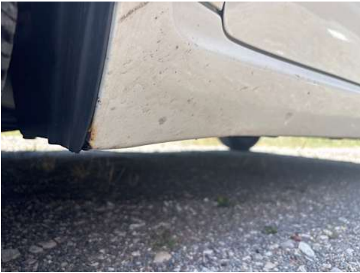
Schweller links (Rost)
