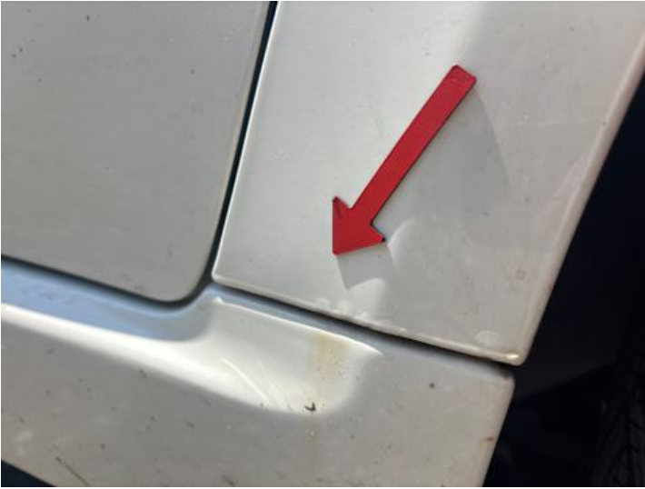
Kotflügel vorne rechts (Rost)
