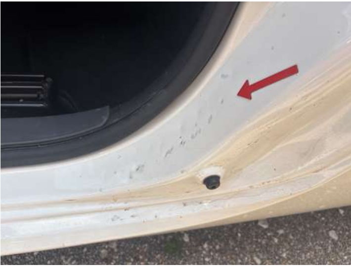
Schweller links (Kratzer, Delle)
