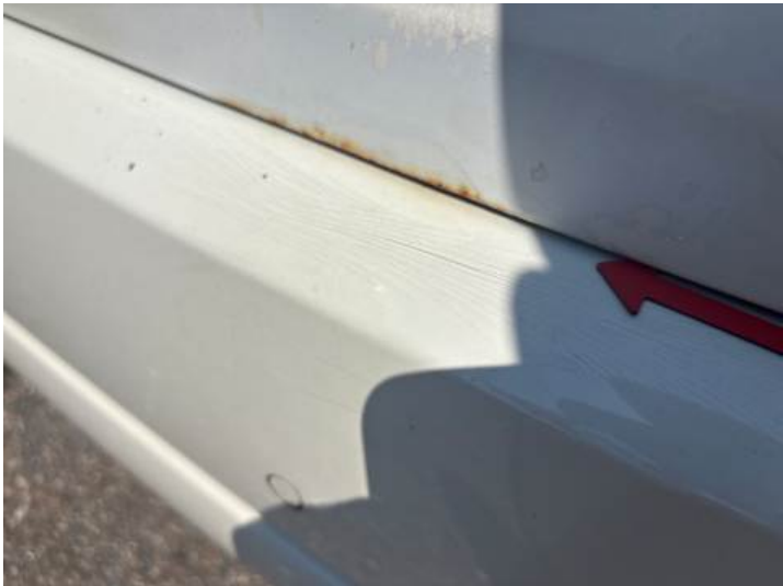
Stoßstange hinten (Lackschaden, Verformung)
