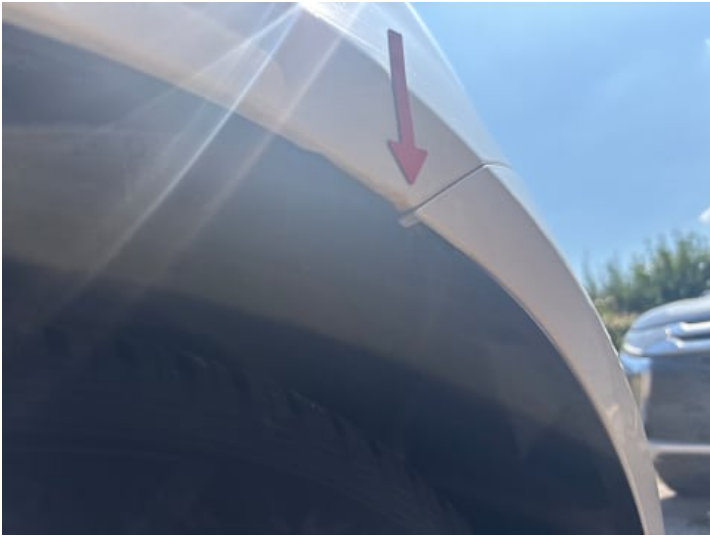
Seitenteil hinten links (Rost)
