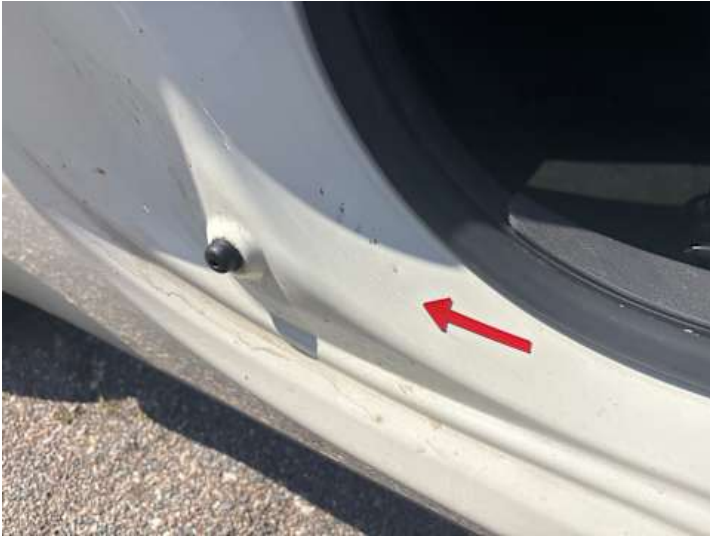
Schweller rechts (Kratzer, Delle)
