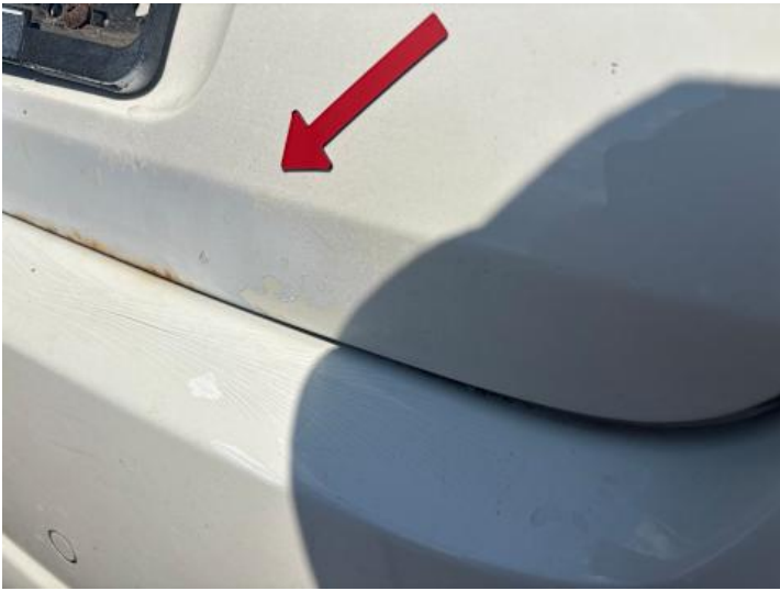
Heckklappe (Kratzer, Rost, Lackschaden, Unsachgemäß instand gesetzt)
