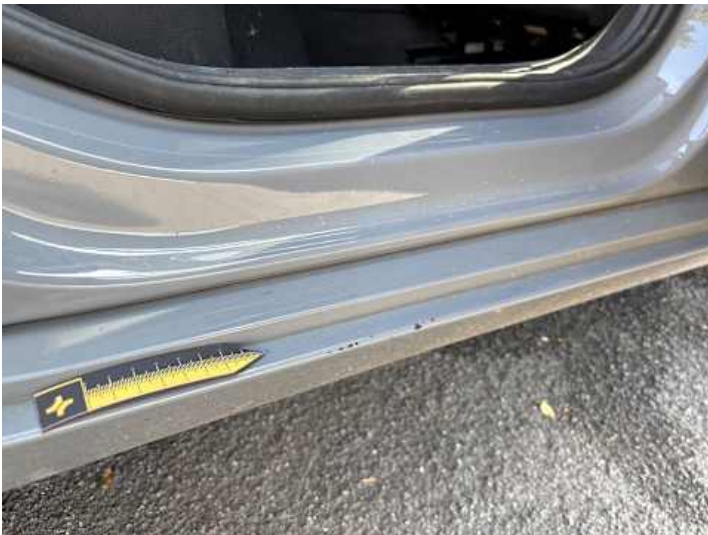
Schweller rechts (Kratzer)
