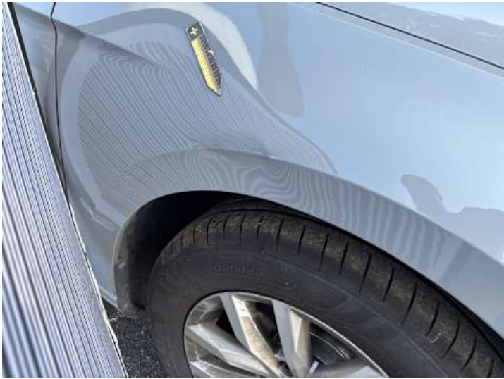
Kotflügel vorne rechts (Verformung)
