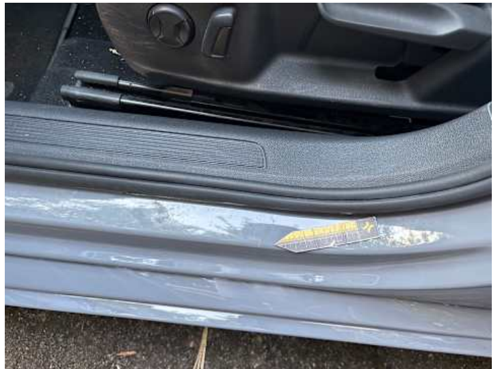
Schweller links (Kratzer)
