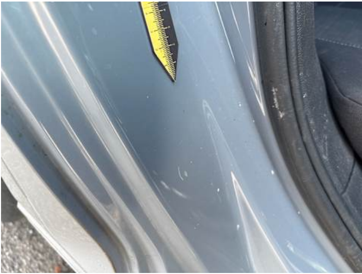
Schweller rechts (Kratzer)
