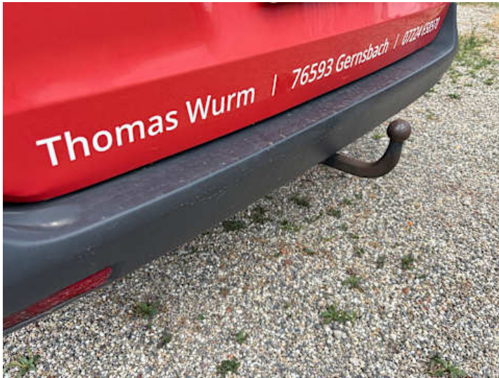
Stoßstange hinten (Kratzer, Verformung)
