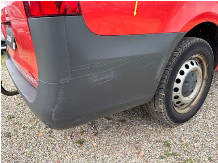
Stoßstange hinten (Kratzer, Verformung)
