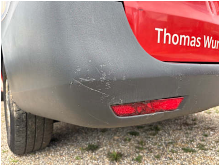
Stoßstange hinten (Kratzer, Verformung)
