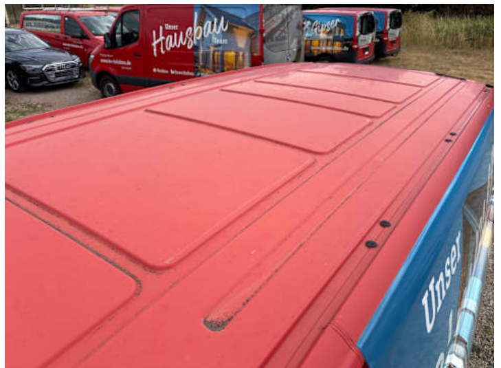
Dach (Delle, Ausgeblichen/Matt)
