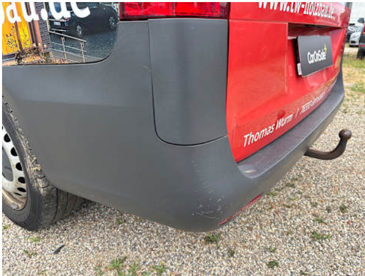
Stoßstange hinten (Kratzer, Verformung)
