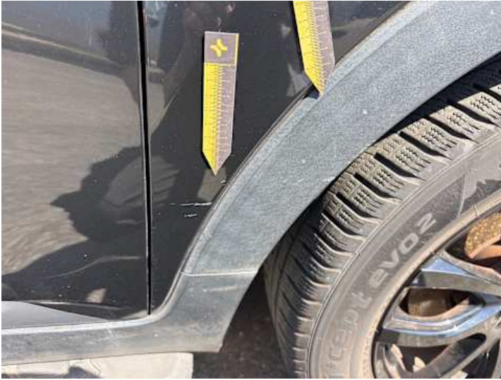
Kotflügel vorne rechts (Kratzer)
