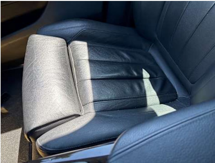
Innenraum (Verschmutzung, Verschleiß)
