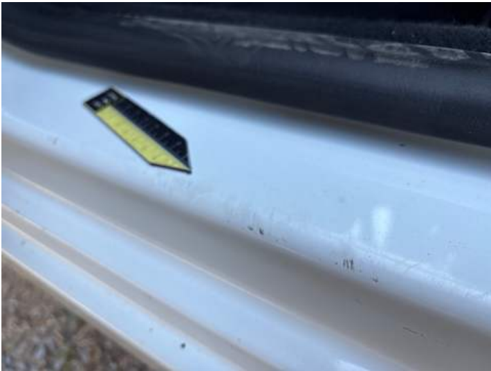
Schweller links (Kratzer)
