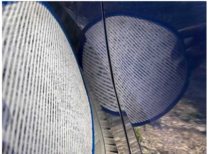
Türe hinten rechts (Delle)
