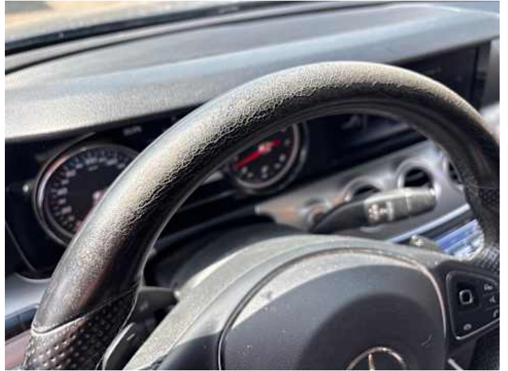
Innenraum (Verschmutzung, Verschleiß)
