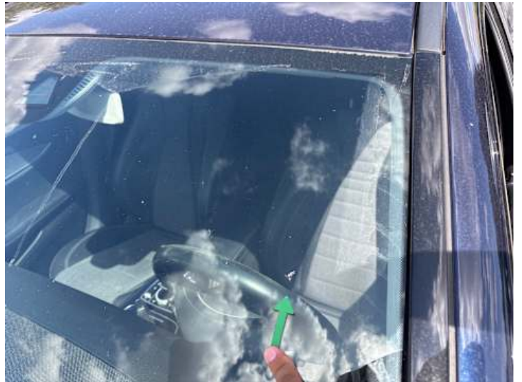
Windschutzscheibe (Steinschlag, Riss/Bruch)
