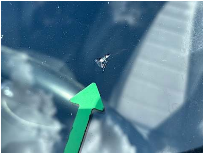
Windschutzscheibe (Steinschlag, Riss/Bruch)
