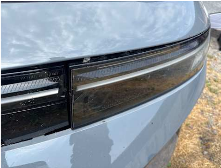
Scheinwerfer (links) (Anderer Schaden): Spaltmaß N.i.O
