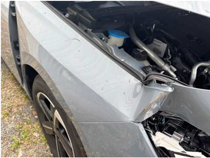
Kotflügel vorne rechts (Kratzer, Verformung)
