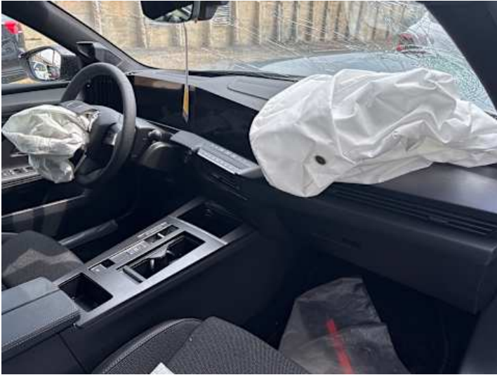
Innenraum (Riss/Bruch, Airbag offen)
