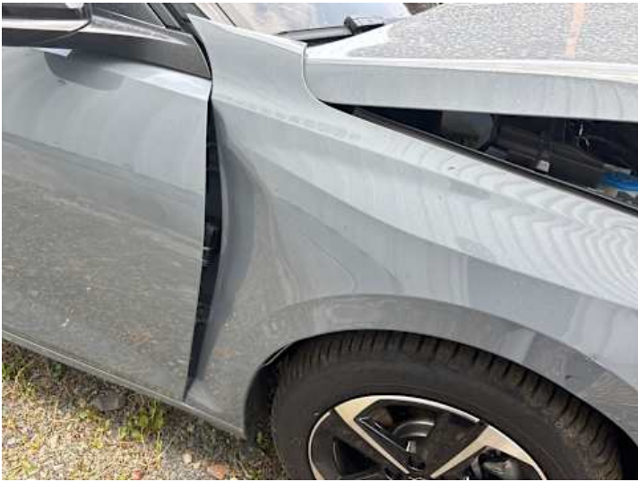
Kotflügel vorne rechts (Kratzer, Verformung)
