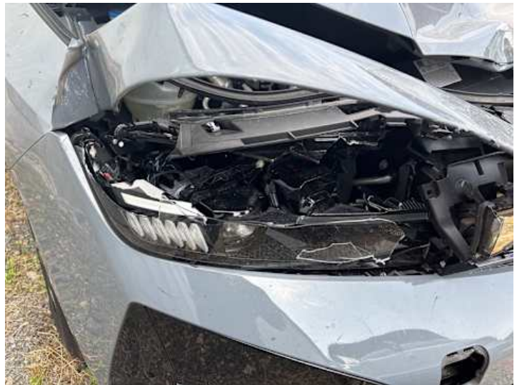
Scheinwerfer (rechts) (Riss/Bruch)
