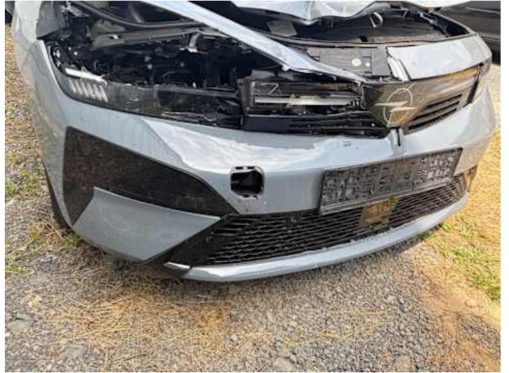
Stoßstange vorne (Verformung, Riss/Bruch)
