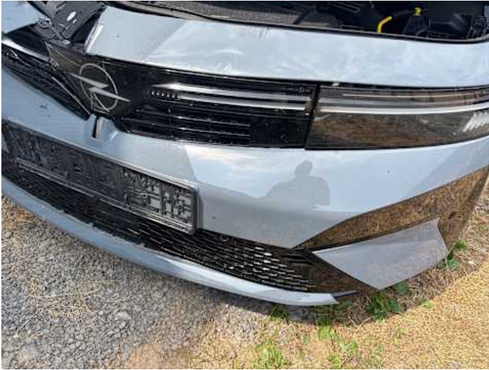
Stoßstange vorne (Verformung, Riss/Bruch)
