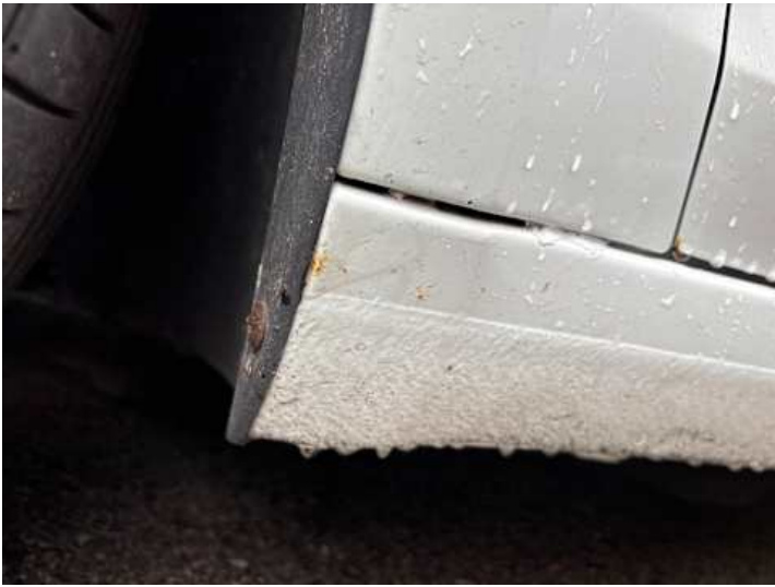
Schweller links (Rost)
