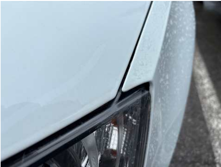
Kotflügel vorne links (Spaltmaße ungenau)
