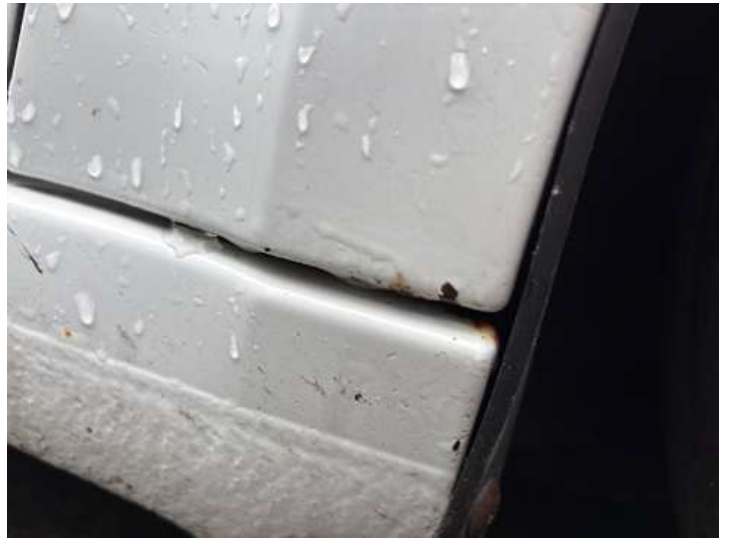
Kotflügel vorne rechts (Rost)
