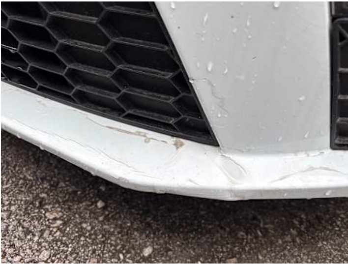
Stoßstange vorne (Riss/Bruch, Verformung, Lackschaden)
