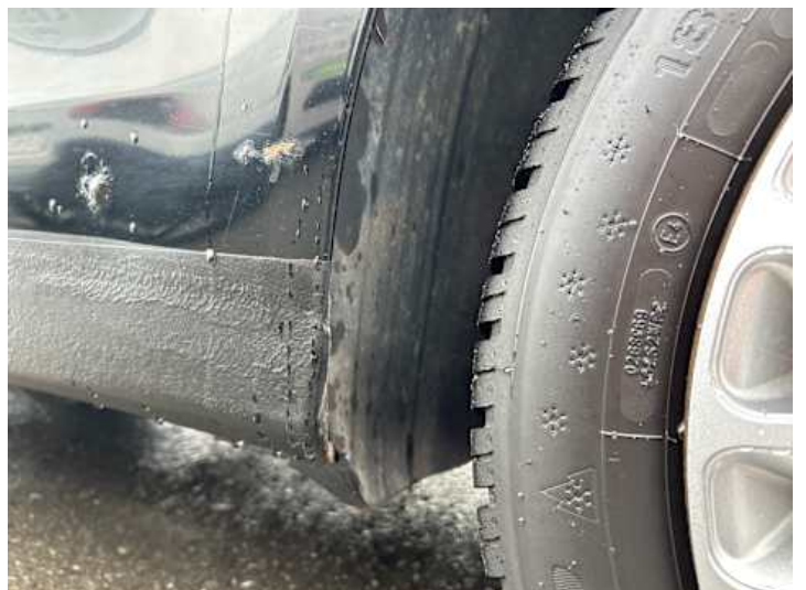
Schweller links (Rost)
