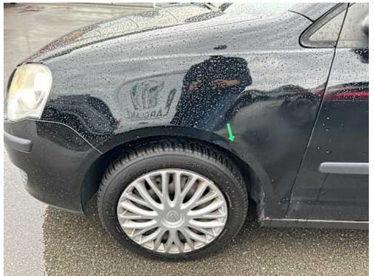
Kotflügel vorne links (Kratzer, Verformung)
