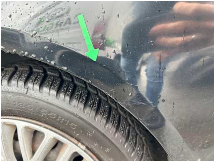
Kotflügel vorne links (Kratzer, Verformung)
