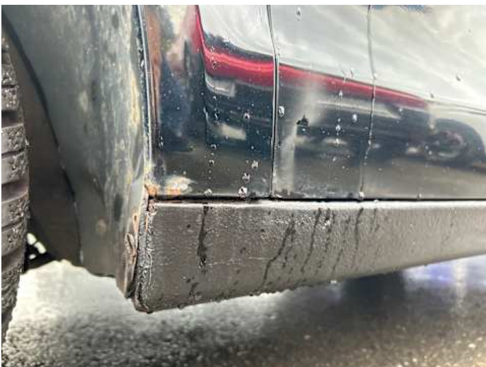
Schweller links (Rost)
