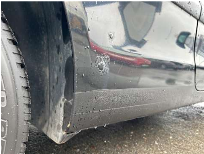
Schweller rechts (Rost)
