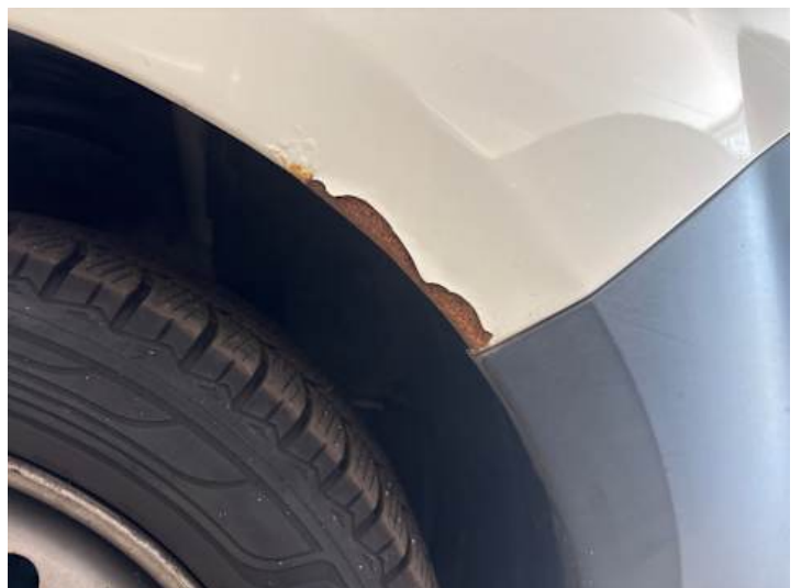
Kotflügel vorne rechts (Rost, Lackschaden)
