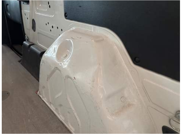
Innenraum (Anderer Schaden, Kratzer): Delle
