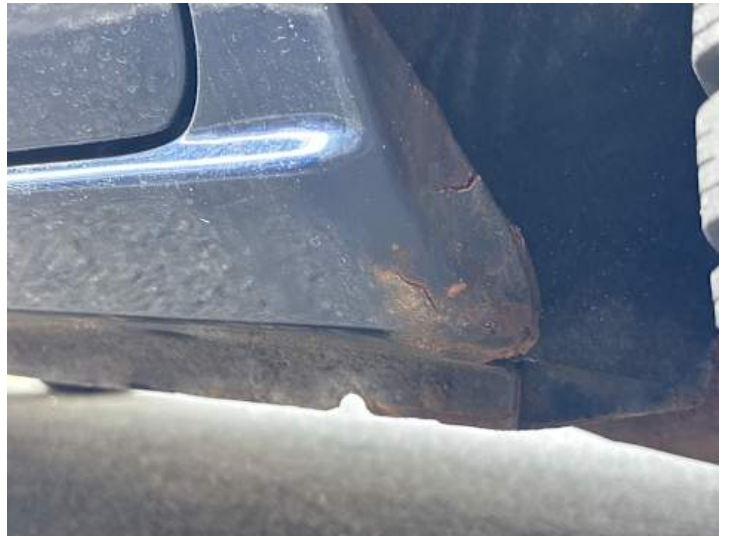
Schweller links (Rost)
