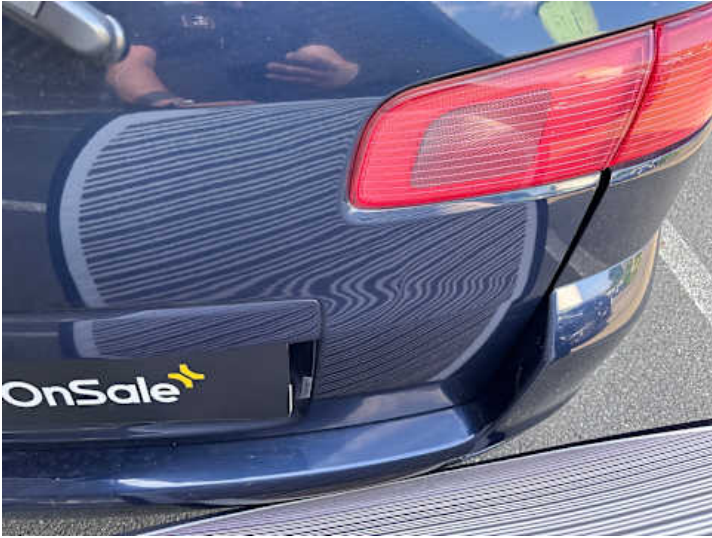
Heckklappe (Lackschaden, Verformung)
