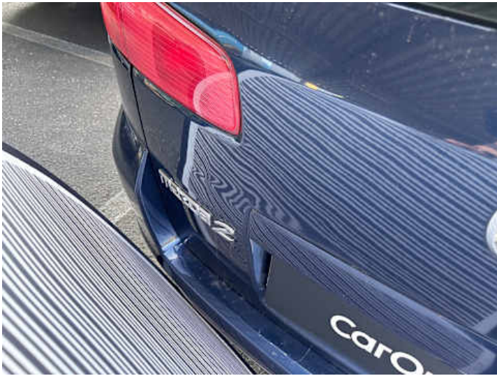
Heckklappe (Lackschaden, Verformung)
