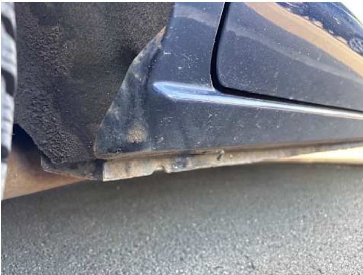
Schweller rechts (Rost)
