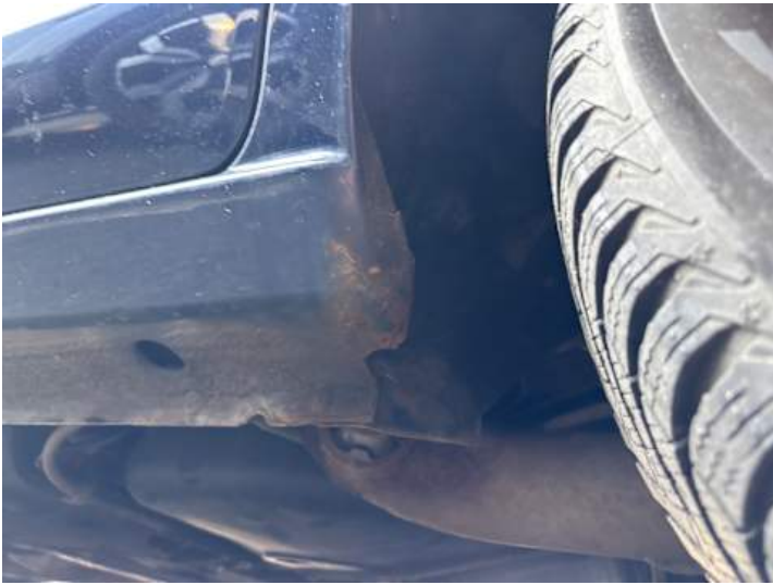
Schweller links (Rost)
