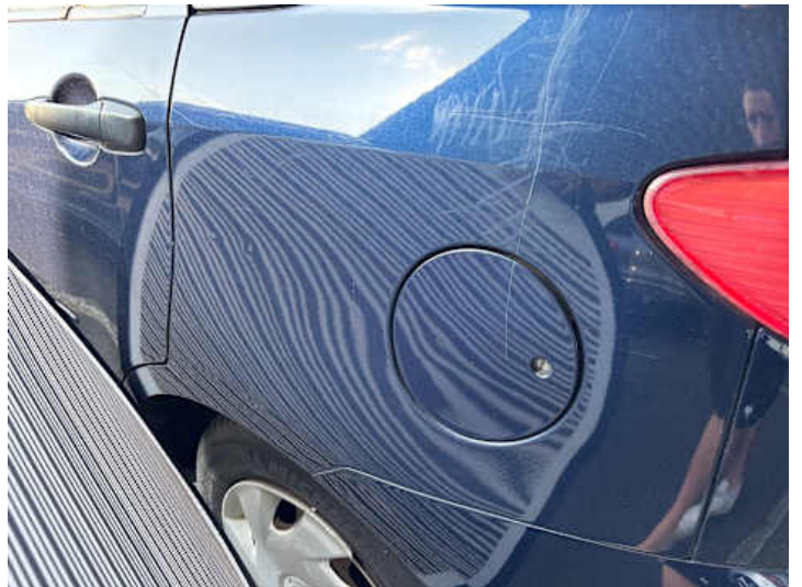
Seitenteil hinten links (Delle, Kratzer, Lackschaden)
