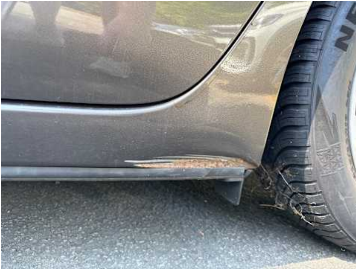
Schweller links (Rost, Verformung)
