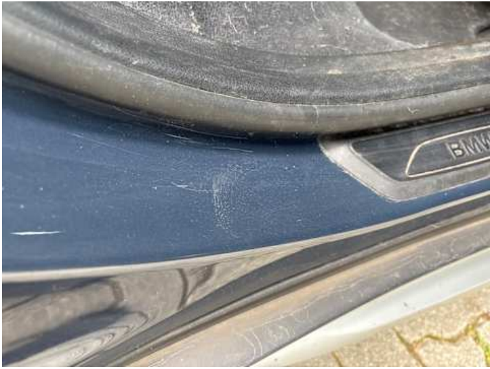
Schweller rechts (Kratzer)
