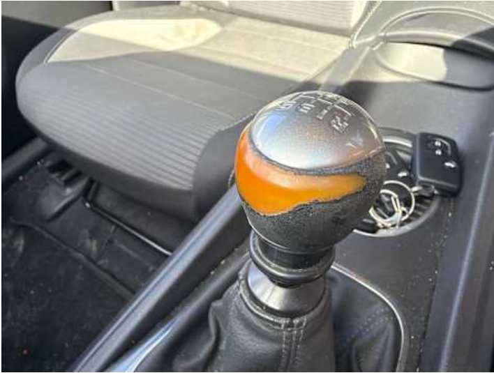
Innenraum (Verschleiß, Verschmutzung)
