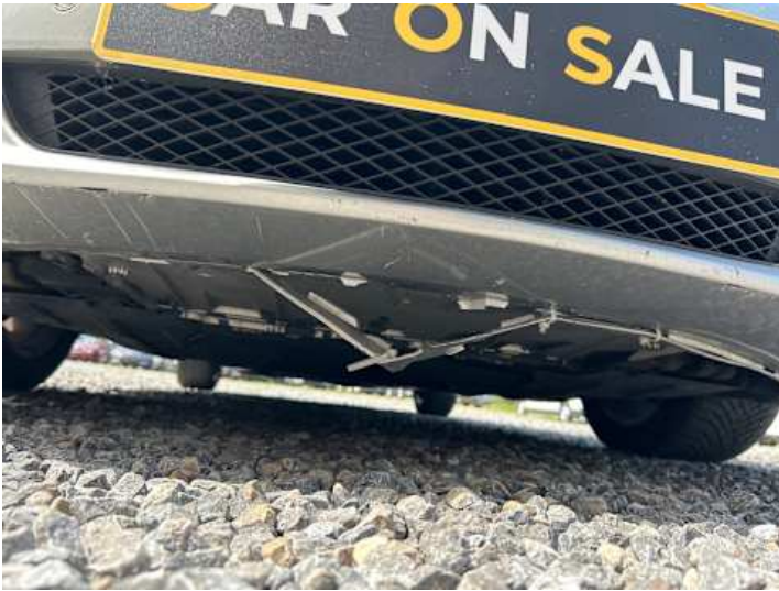
Stoßstange vorne (Riss/Bruch)
