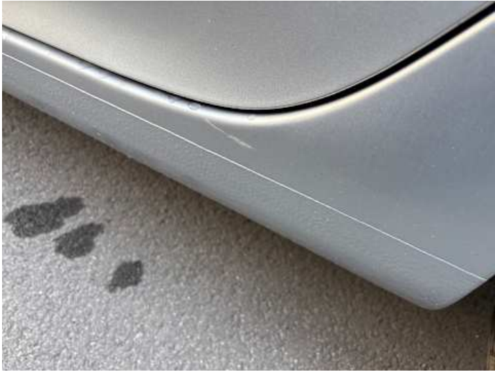
Schweller links (Kratzer)
