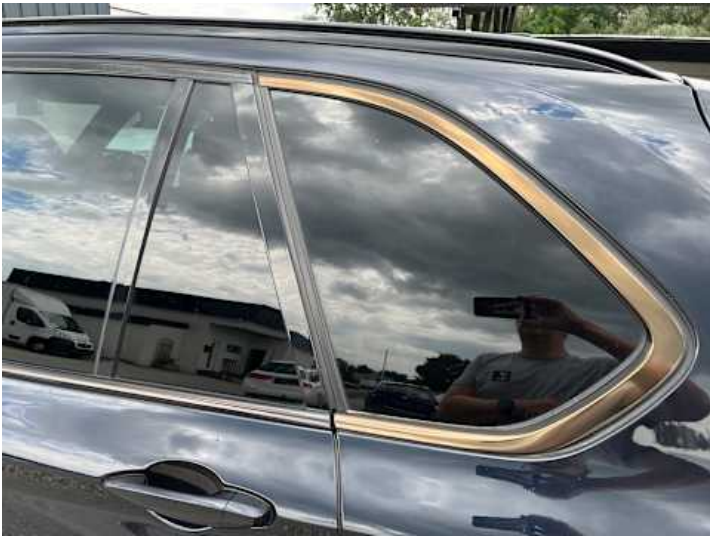
Seitenteil hinten links (Anderer Schaden): Verfärbung
