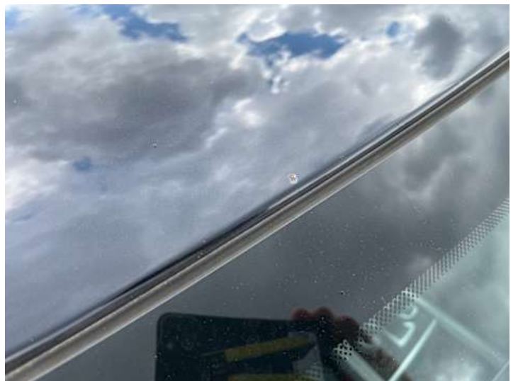
Dach (Steinschlag, Rost)
