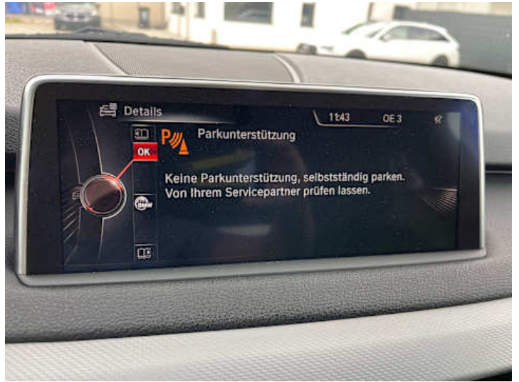
Innenraum (Anderer Schaden): PDC ohne Funktion
