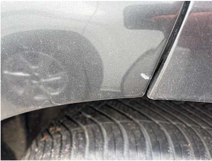
Türe hinten links (Lackschaden)
