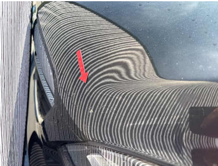
Motorhaube (Delle, Steinschlag)
