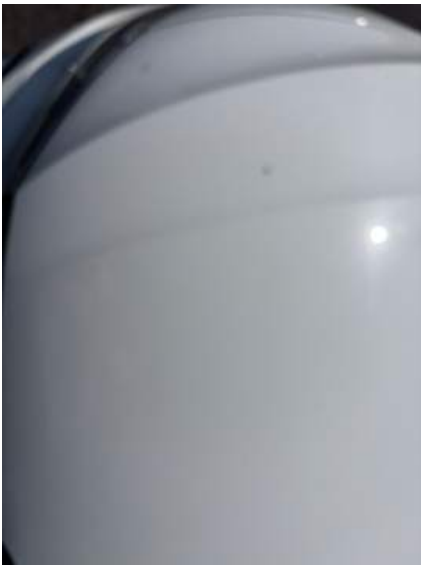
Motorhaube (Steinschlag, Lackschaden)
