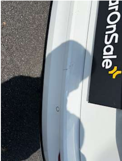
Stoßstange hinten (Lackschaden, Verformung)
