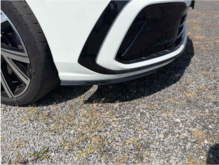
Stoßstange vorne (Kratzer, Lackschaden, Verformung)
