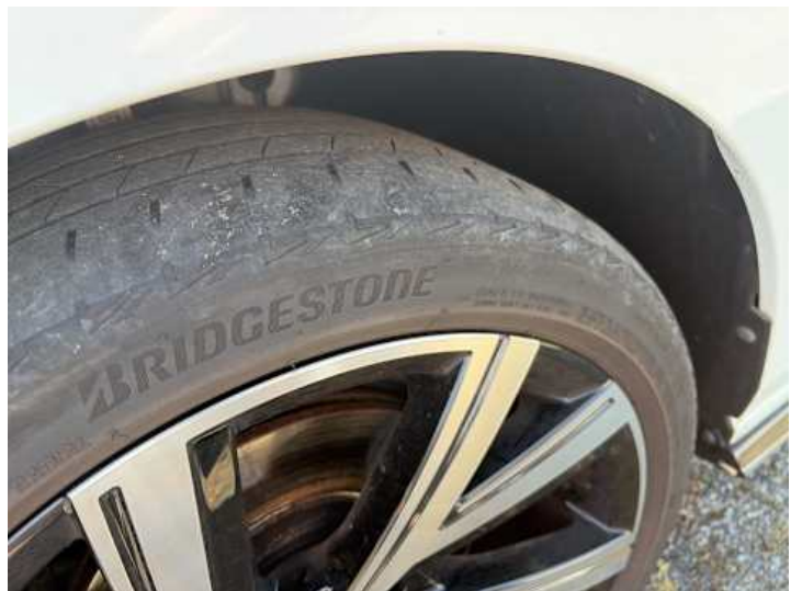
Rad (Ungleichmäßig abgefahren)
