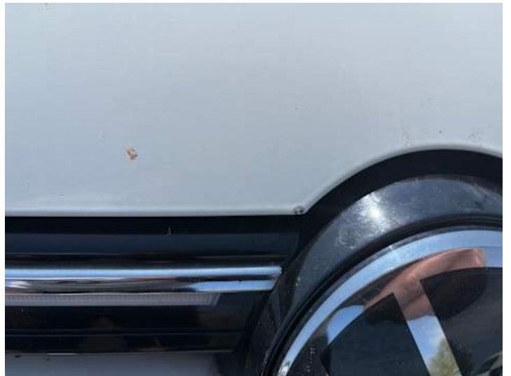
Motorhaube (Steinschlag, Lackschaden)
