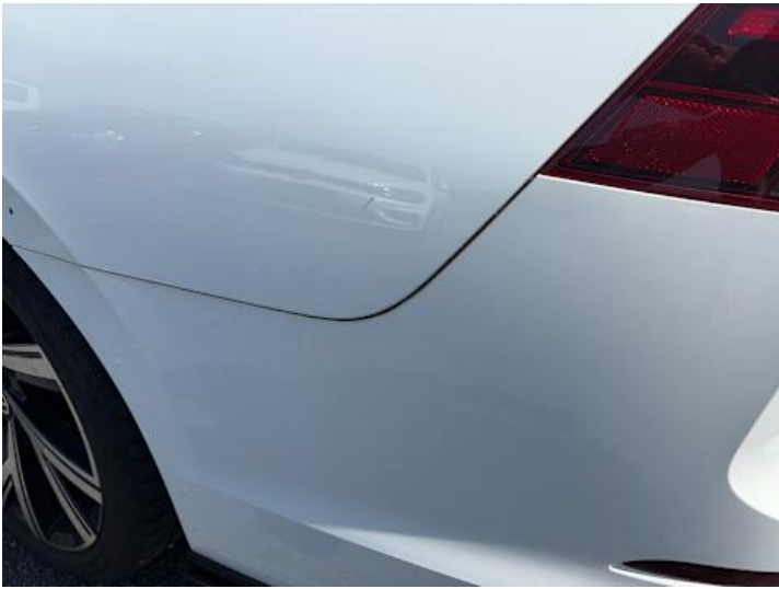
Stoßstange hinten (Spaltmaße ungenau)
