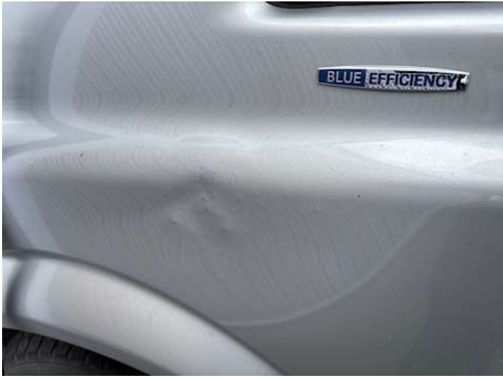
Kotflügel vorne links (Delle, Verformung)
