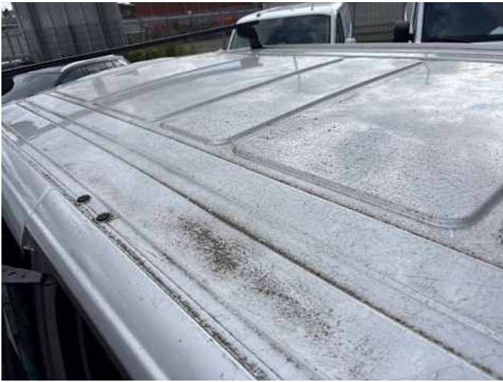
Dach (Delle, Verformung, Kratzer)
