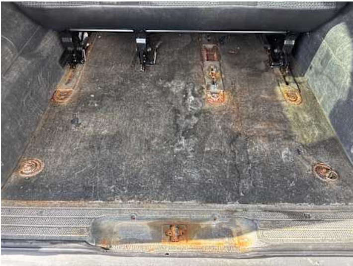
Innenraum (Kratzer, Anderer Schaden): Korrosion
