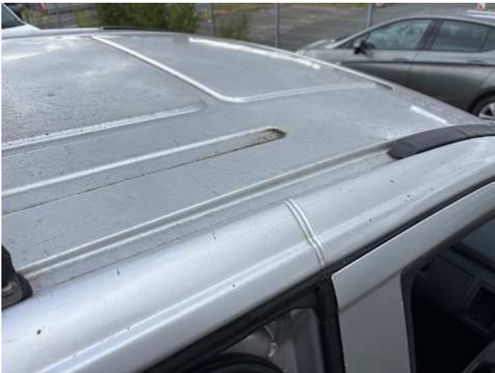
Dach (Delle, Verformung, Kratzer)
