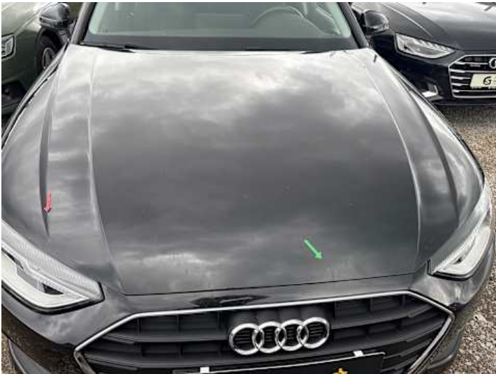
Motorhaube (Kratzer, Steinschlag)
