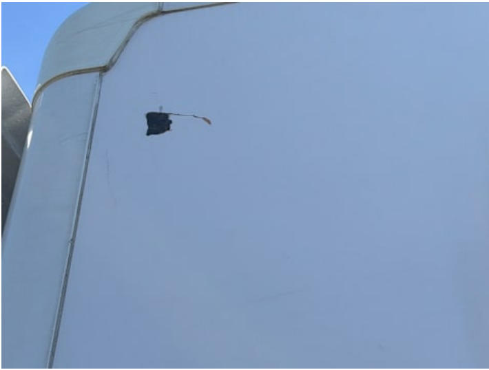
Seitenteil hinten links (Unsachgemäß instand gesetzt)
