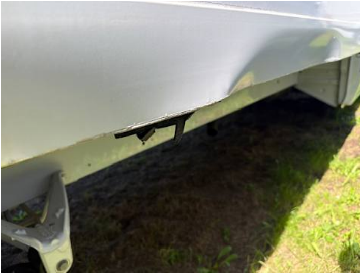
Schweller rechts (Verformung)
