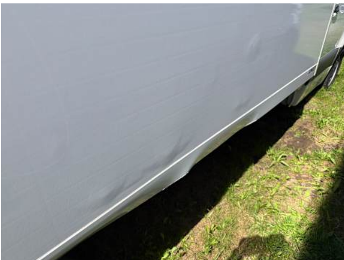
Schweller rechts (Verformung)
