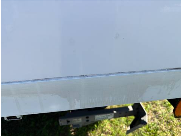
Seitenteil hinten links (Anderer Schaden): Lack abgeblieben
