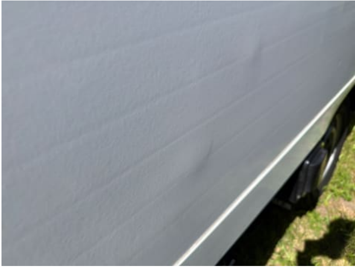
Seitenteil hinten rechts (Delle, Verformung)
