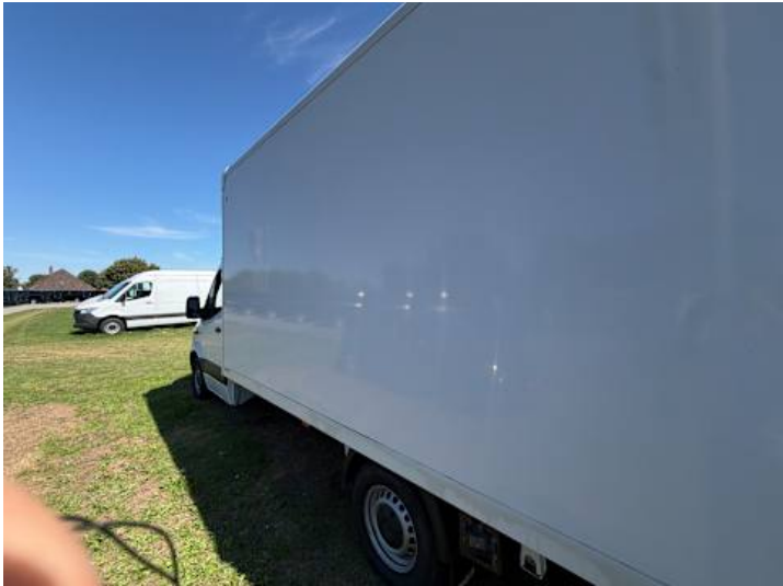
Seitenteil hinten links (Unsachgemäß instand gesetzt)
