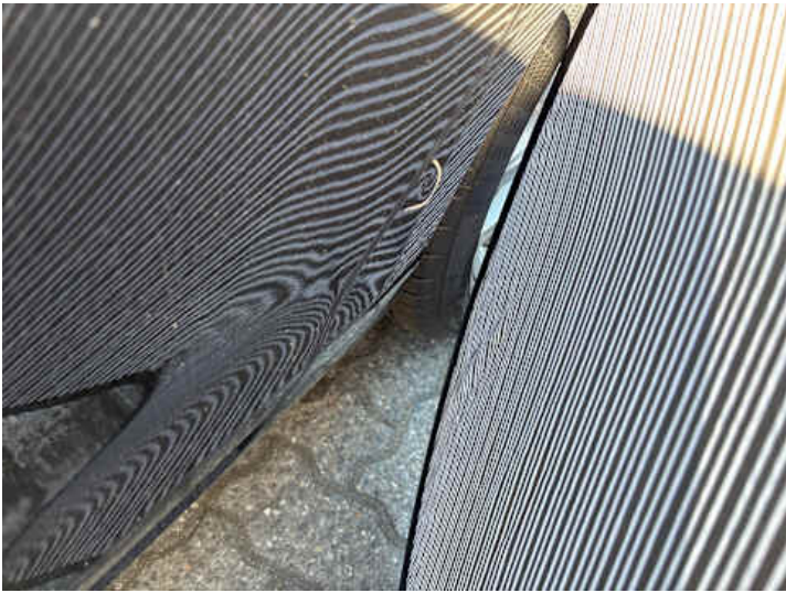
Seitenteil hinten links (Delle)
