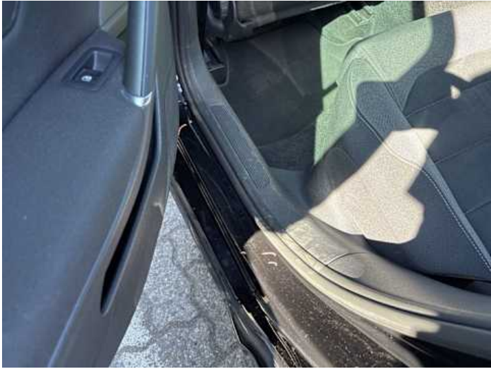
Schweller links (Kratzer)
