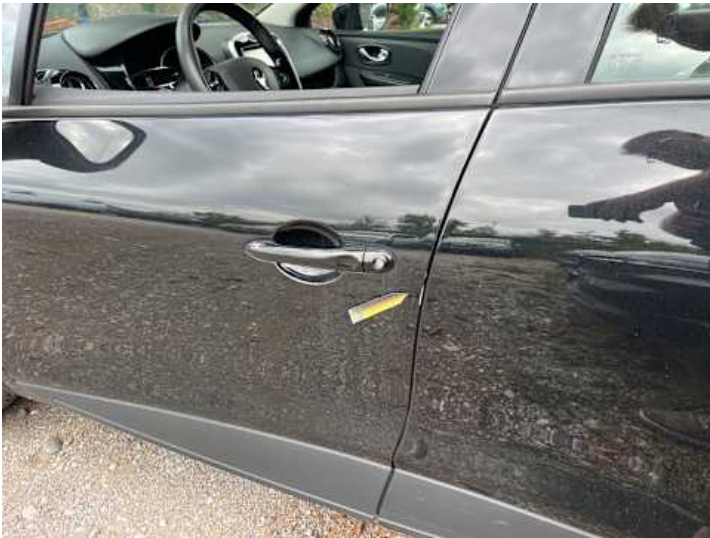
Fahrtür (Lackschaden, Kratzer)
