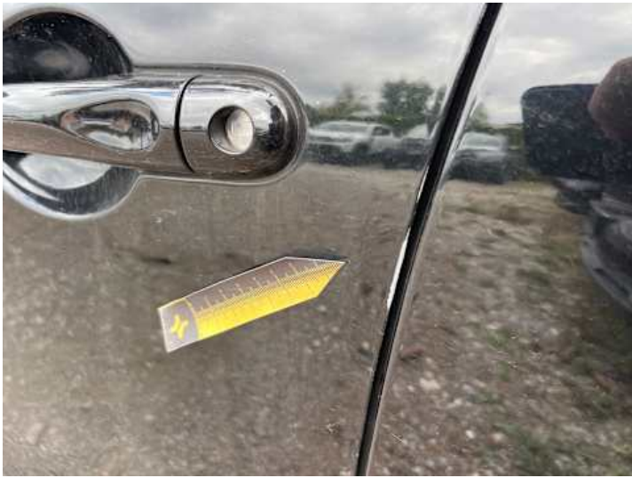
Fahrtür (Lackschaden, Kratzer)
