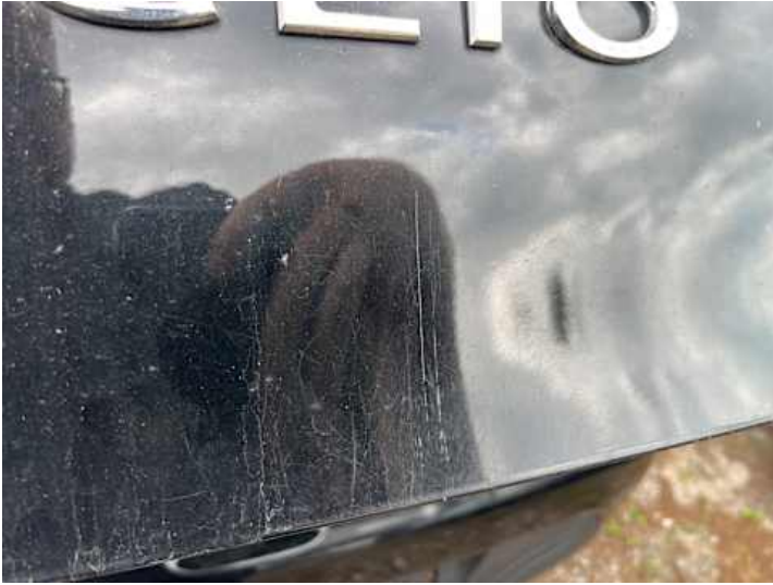
Heckklappe (Kratzer, Lackschaden)
