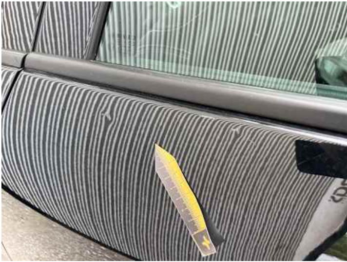
Türe hinten links (Kratzer, Lackschaden, Delle)
