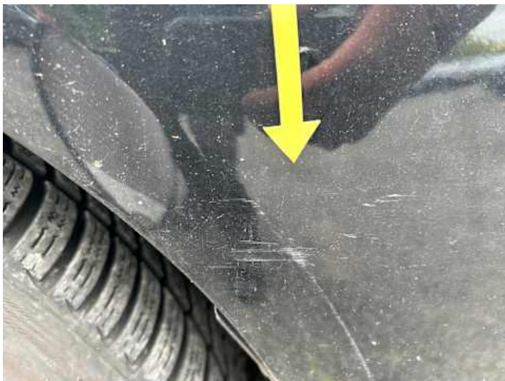
Kotflügel vorne links (Kratzer, Lackschaden)
