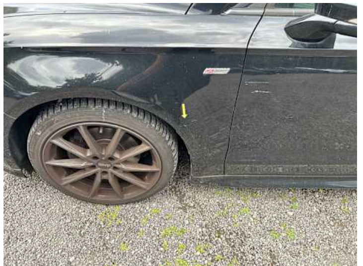
Kotflügel vorne links (Kratzer, Lackschaden)
