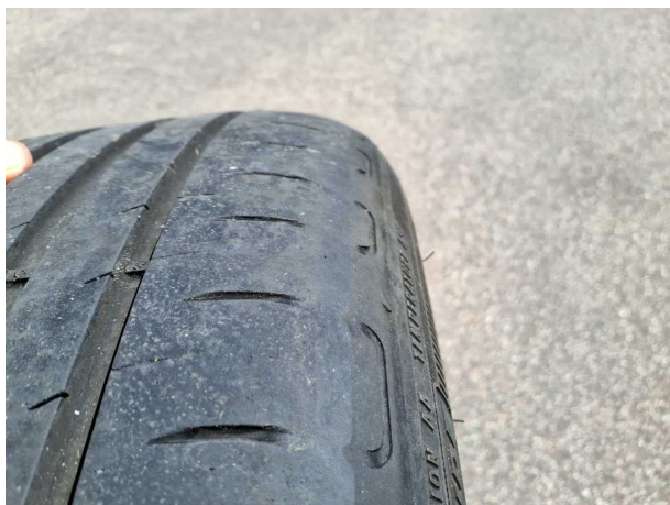
Beschädigung #8: 2.Radsatz: 2 Reifen (Außenprofil) - verschliss... - erneuern
