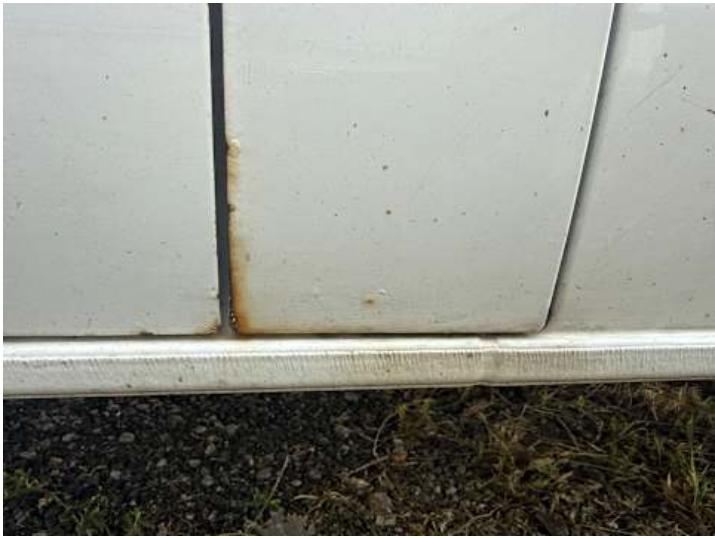
Seitenteil hinten links (Kratzer, Rost)
