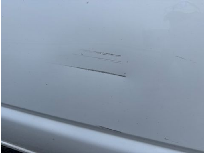
Seitenteil hinten links (Kratzer, Rost)
