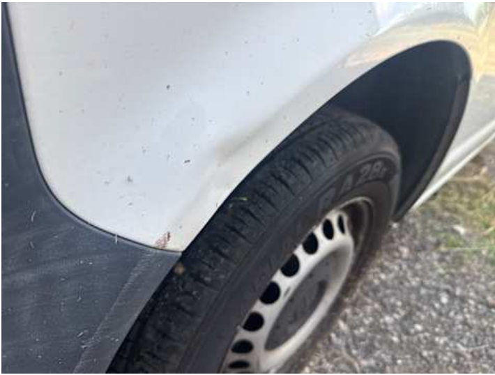
Kotflügel vorne links (Verformung)
