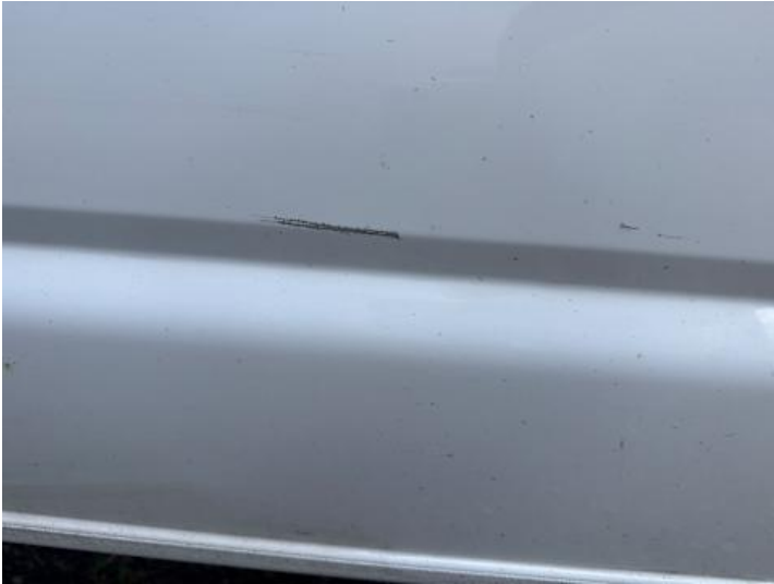
Seitenteil hinten links (Kratzer, Rost)
