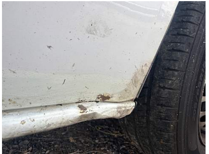
Beifahrertür (Lackschaden, Rost)
