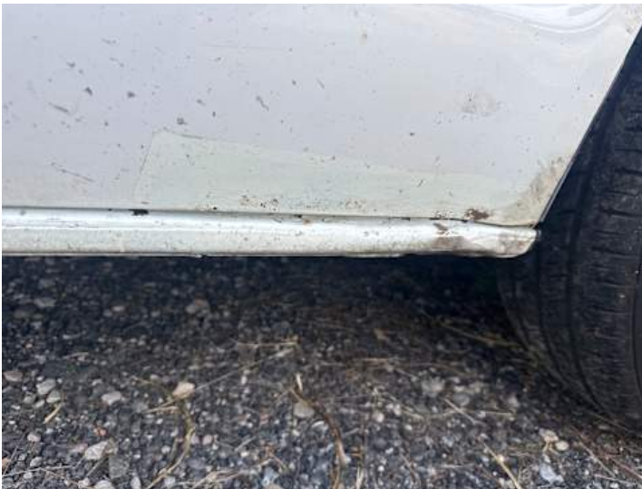
Beifahrertür (Lackschaden, Rost)
