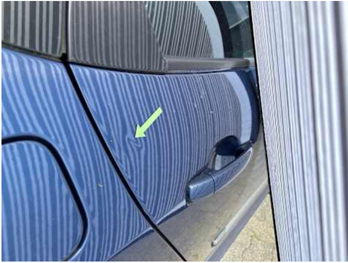
Türe hinten rechts (Delle)
