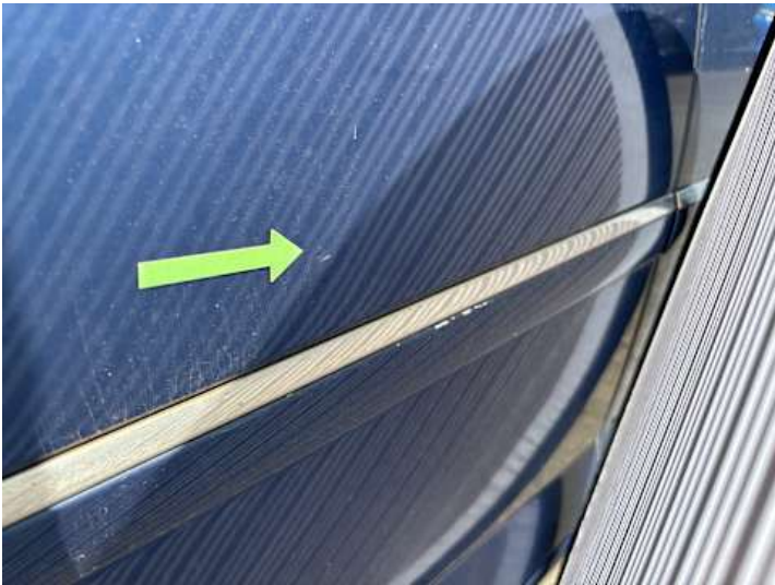
Türe hinten rechts (Delle)
